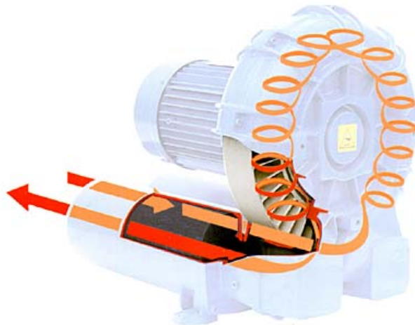
Şekil 1.15 Negatif basınçlı ileticilerde kullanılan yan kanallı vakum sistemi ( www.zema-aritma.com/blower.htm , 2007)
