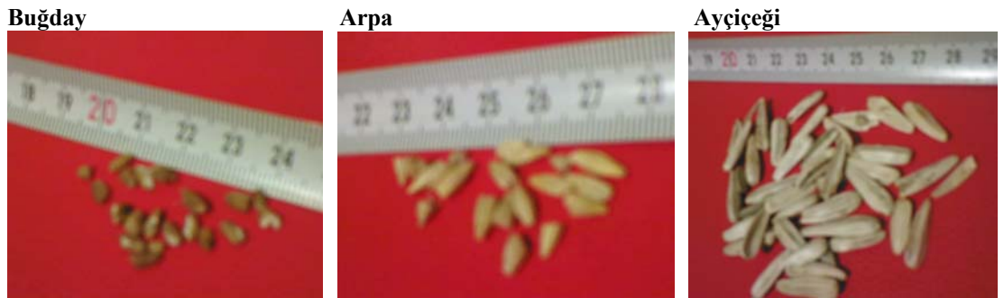
Şekil 3.5 Materyallerde meydana gelen mekanik zedelenmeler
