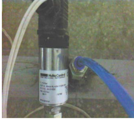
Şekil 3.3 Denemelerde kullanılan basınç transmitteri ve dijital gösterge ( http://www.emkoelektronik.com.tr/turkish/prsgosterge.php , 2007)
