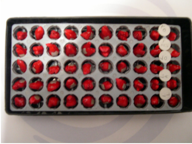
Şekil 3.6 % 0.5 lik Bazik Fuksin Solusyonuna Yerleştirilmiş Örnekler.
