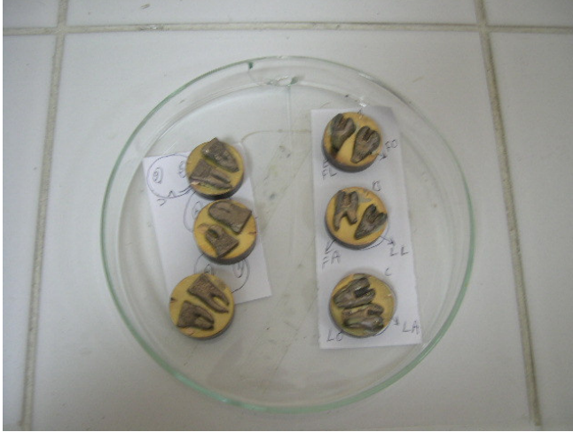
Şekil 3.3 SEM İçin Hazırlanmış Örnekler.
