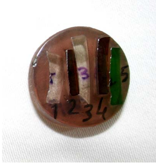
Resim 6. SEM-EDS cihazında incelenen şişe numunelerinin görüntüsü
