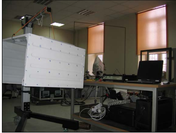
Şekil 4.9 : Çamaşır makinası gövdesi ölçüm noktaları ve asılış şekli.
