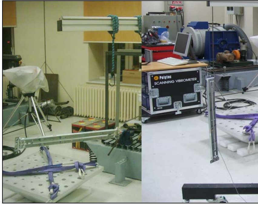
Şekil 4.7 : Askı sacının değişik asılış biçimleri.
