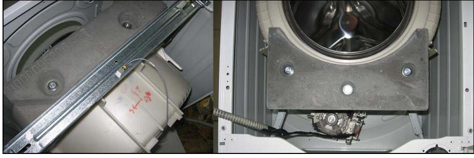
Şekil 5.3 : Solda üst beton, sağda alt beton.
