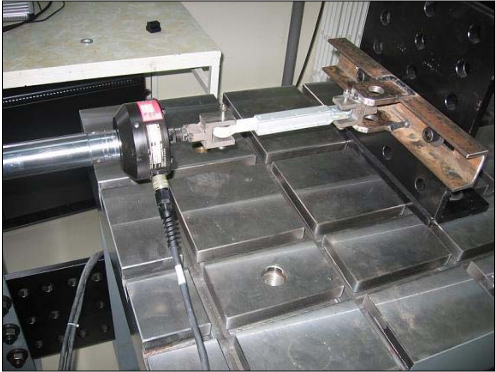
Şekil 4.13 : Amortisörün test cihazına tutturulması.
