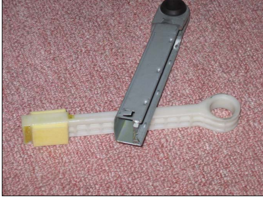
Şekil 4.11 : Amortisör çerçevesi ve yağa batırılmış keçe.
