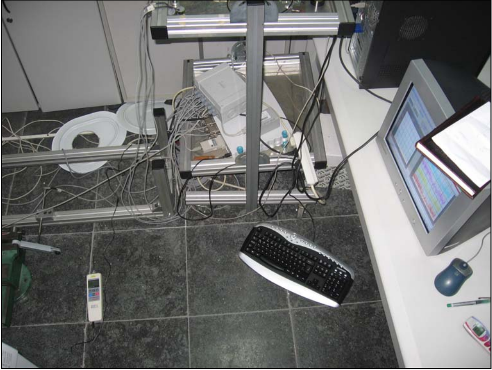
Şekil 4.17 : HBM ivme deplasman ölçüm sistemi.
