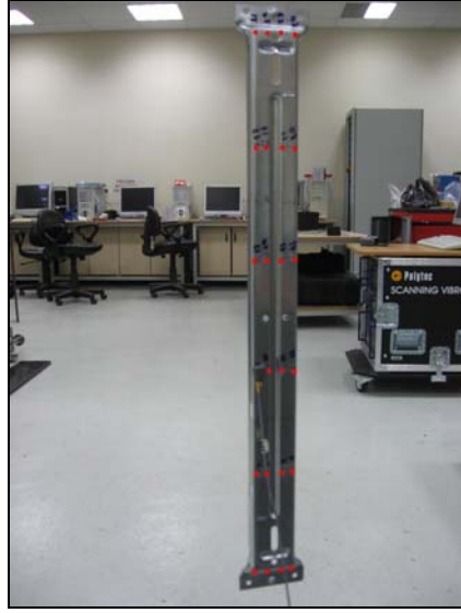
Şekil 4.6 : Yay askı sacı ölçüm noktaları.
