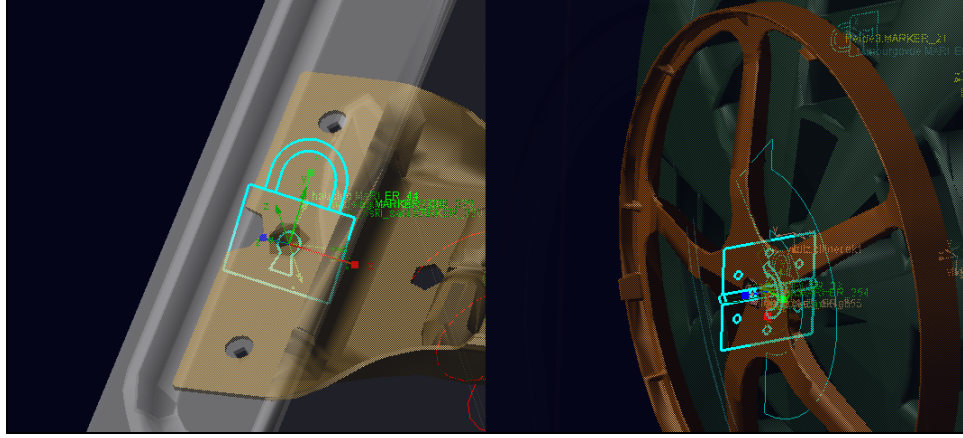
Şekil 6.2 : Solda sabit mafsalsal, sağda döner mafsalsal.
