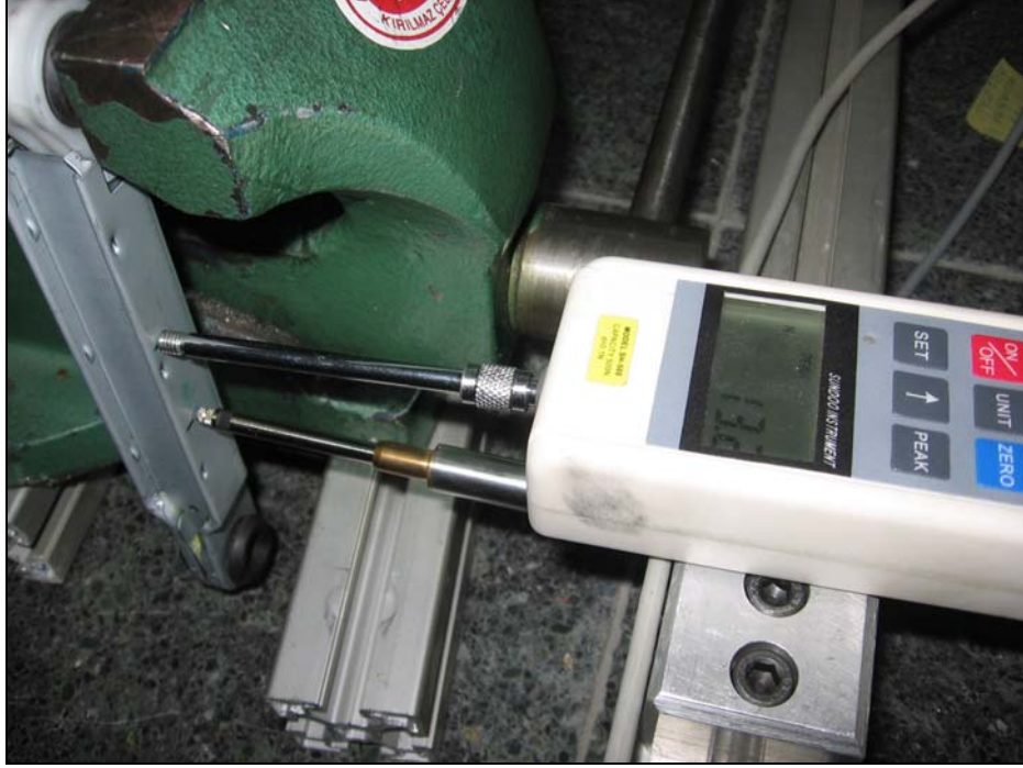
Şekil 4.16 : Lastiklerin dönme katılıklarının ölçülmesi.
