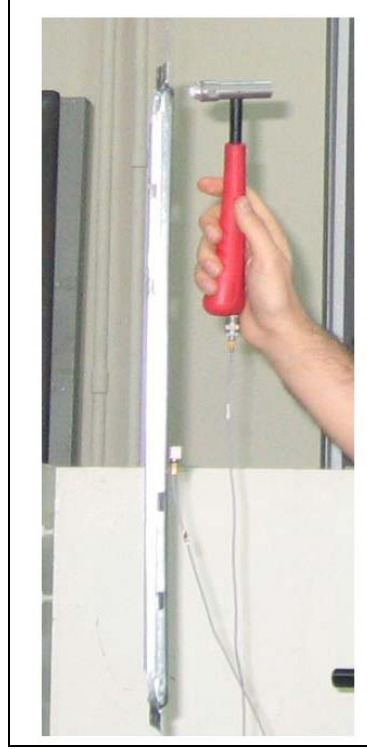
Şekil 4.8 : Askı sacının modal çekiçle tahrik edilmesi.
