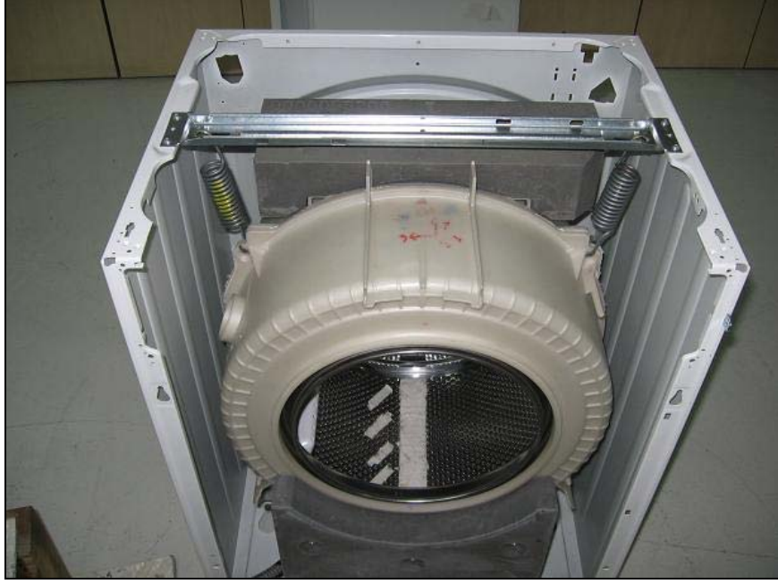
Şekil 6.6 : Tamburuna dengesiz yük bağlanmış test makinası.
