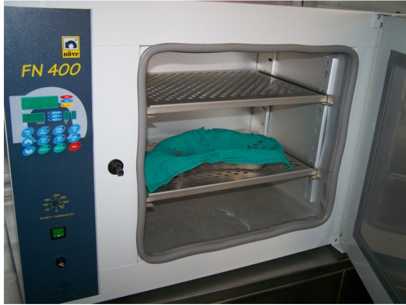
Resim 9. Alınan örneklerin dehidratasyon amacıyla otoklava bırakılmaları görülüyor.
