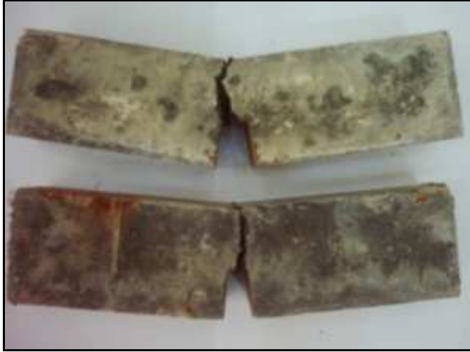
Şekil E.10: OZN ve OZS numunelerinin kırılma şekli.
