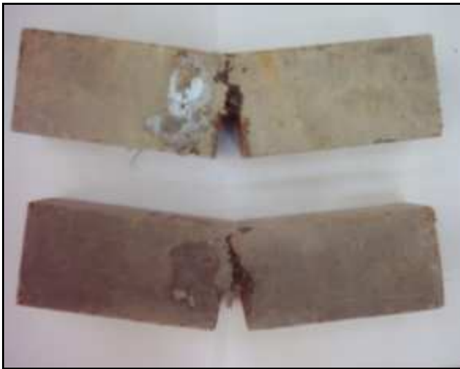
Şekil E.11: OXN ve OXS numunelerinin kırılma şekli.
