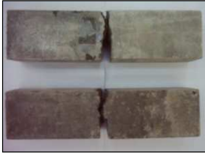
Şekil E.7: ON ve OS numunelerinin kırılma şekli.
