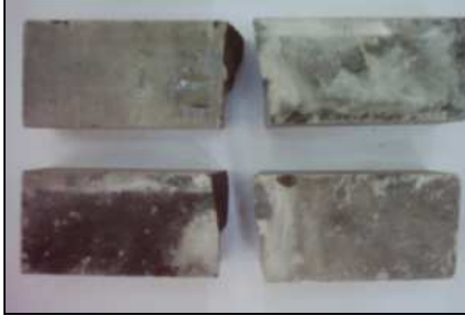
Şekil E.6: MN ve MS numunelerinin kırılma şekli.
