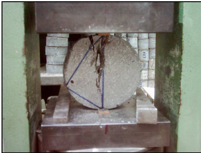
Şekil E.5: Yarmada çekme deneyi uygulanmış lifli numune.
