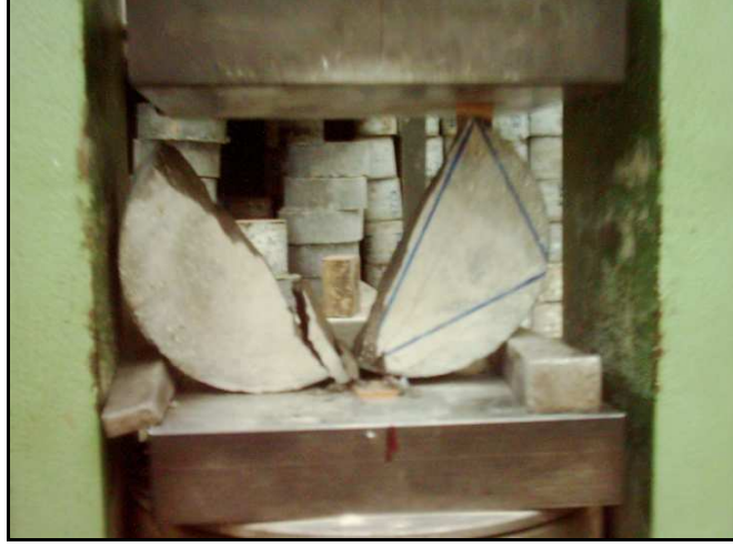
Şekil E.3: Yarmada çekme deneyi uygulanmış, lifsiz ve normal kürlü numune.
