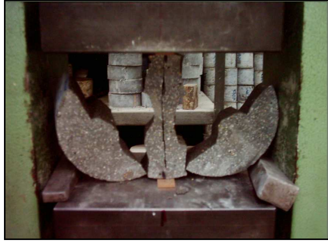
Şekil E.4: Yarmada çekme deneyi uygulanmış, lifsiz ve buhar kürlü numune.
