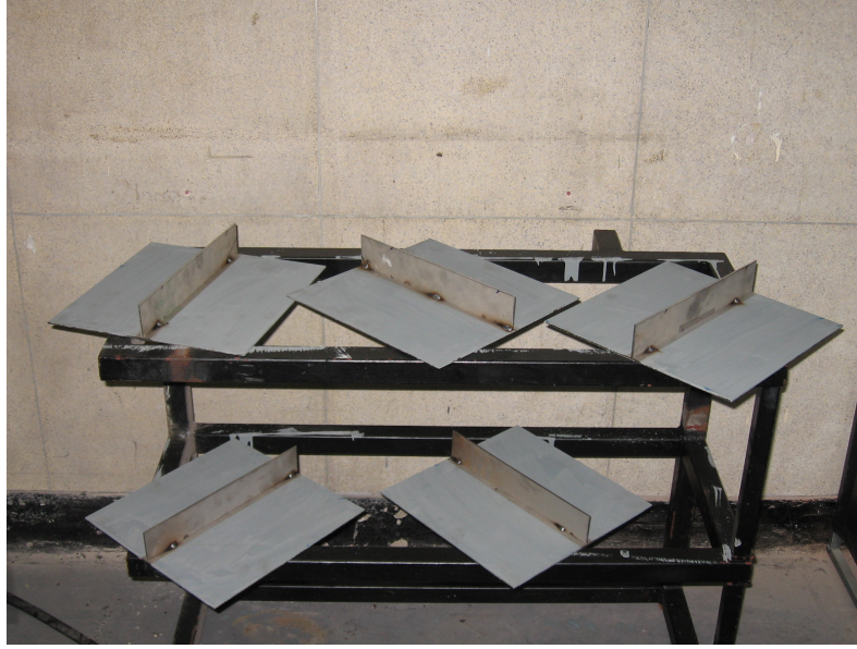
Şekil 5.11: Deneyde kullanılacak malzemelerin termal kamera için boyanması
