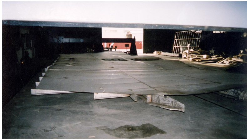
Şekil 4.6: Kaynak sonrası distorsiyona uğramış parça
