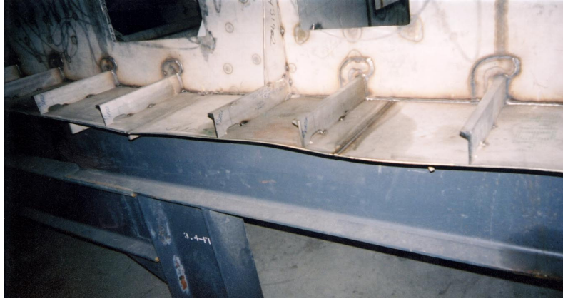
Şekil 4.5: Kaynak sonrası distorsiyona uğramış parça
