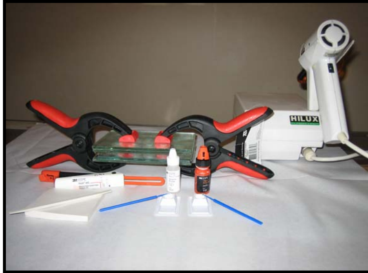
Resim 28. Rely X ARC rezin simanı seti, Hilux ışın cihazı ve hermetik kuvvet uygulanan örnekler
