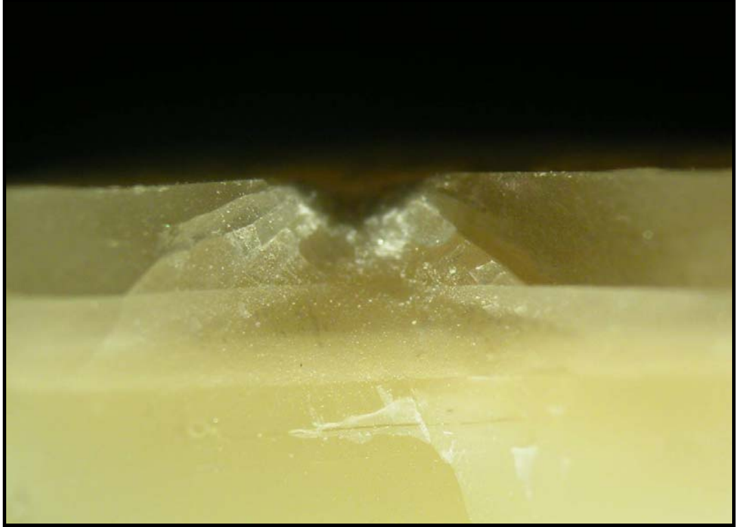
Şekil 6. 2. Grup In-Ceram Alumina tam-seramik örneğin bağlı arayüz tekniği kullanılarak elde edilen kesit görüntüsü
