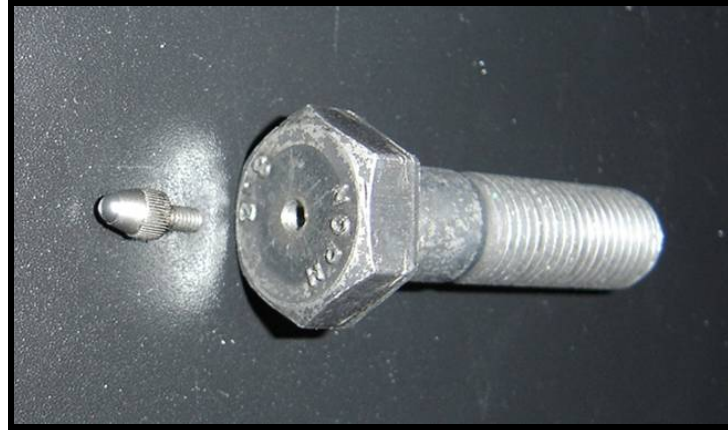
Resim 36. Tungsten karbit küre için ikinci bir vida üzerinde yiv açılması
