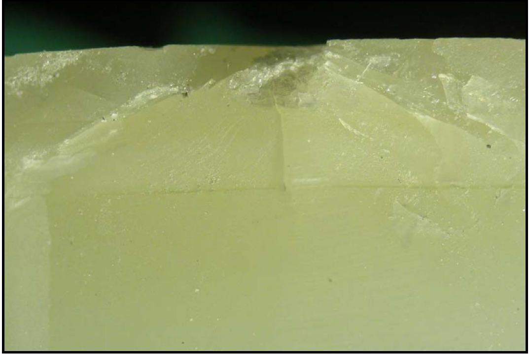
Şekil 2. 1. Grup Empress II (çift tabaka) tam-seramik örneğin bağlı arayüz tekniği kullanılarak elde edilen kesit görüntüsü
