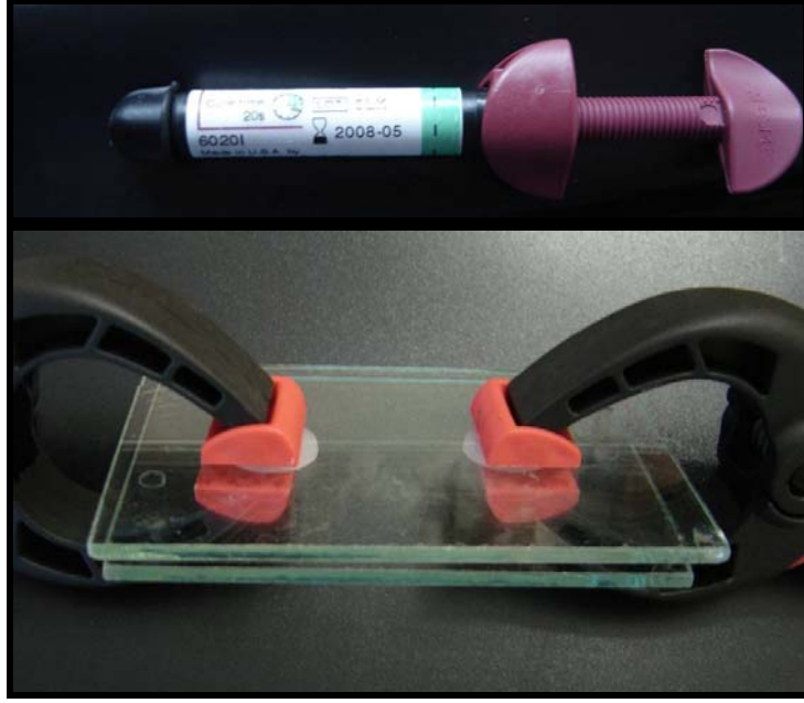
Resim 24. Z250 dental kompozitler üzerine, kalıpların arasında hermetik kuvvetin uygulanışı
