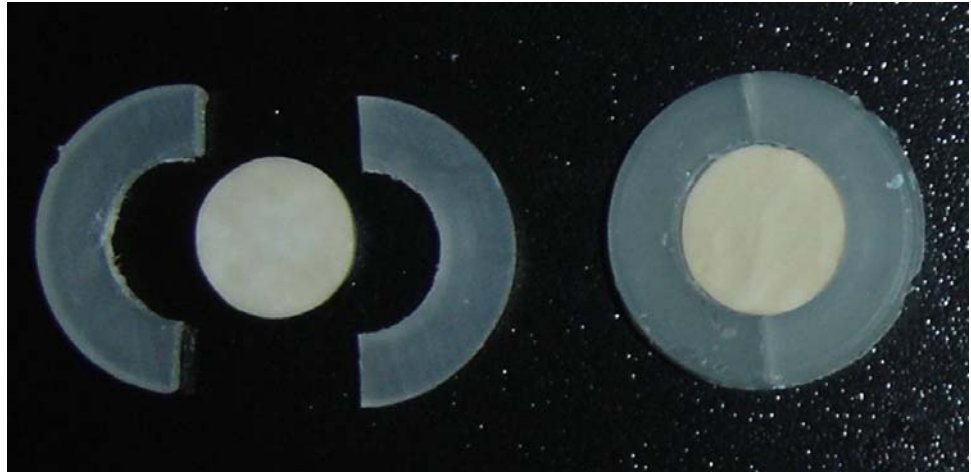
Resim 11. Kaplama seramiğinin standart yerleştirilmesi için modifiye edilen kalıplar.
