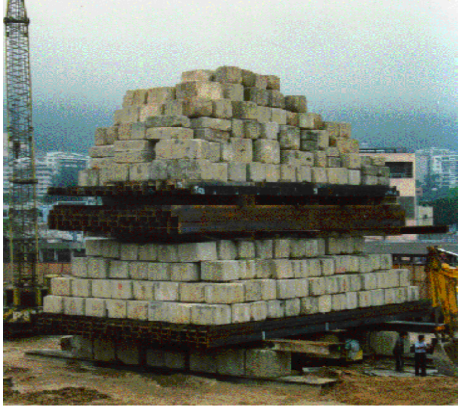
Şekil 2.11 : Kazık Yükleme Deneyi ( http://www.aliai.lu )
