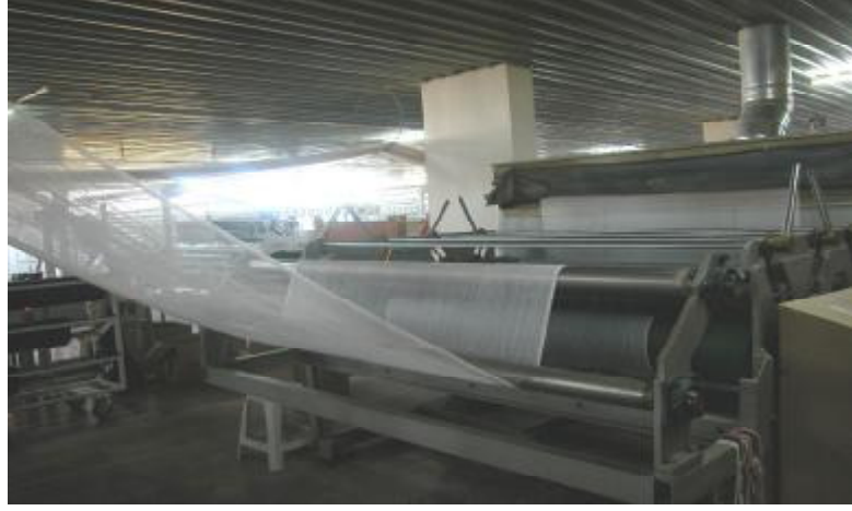
Şekil 4.17. Ağların ütülenmesinde kullanılan germe makinesi
