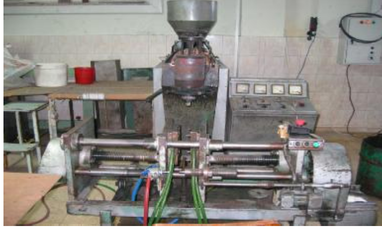
Şekil 4.33. Yüzdürücü imalinde kullanılan plastik mantar makinesi
