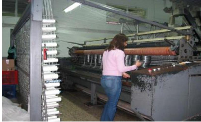
Şekil 4.7. Disklere sarılan iplik dokuma makinesine takılmaktadır
