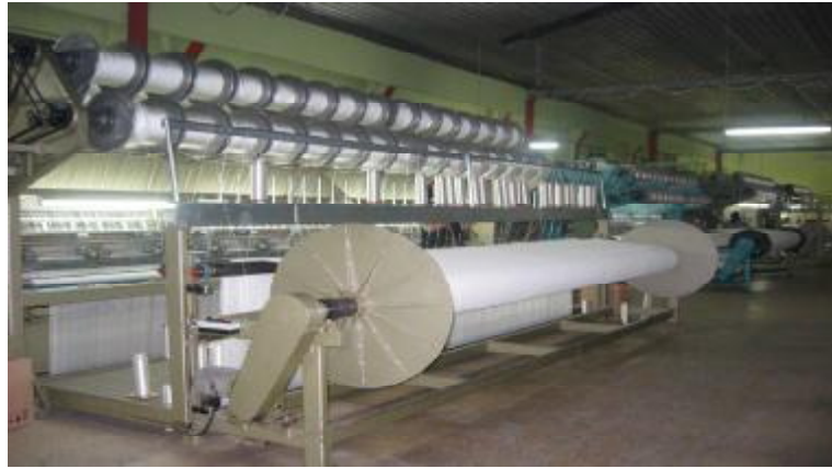
Şekil 4.11. Düğümsüz ağ yapılan dokuma makinesi
