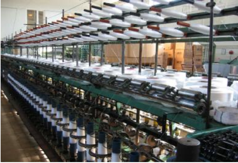
Şekil 4.5. Tek kat ipliği ağ ipliğine dönüştüren katlama makinesi
