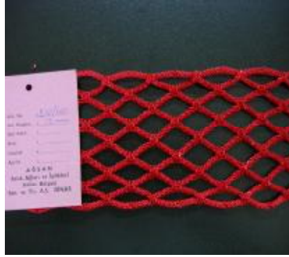
Şekil 4.23. Fabrikada üretilen altıgen ve baklava gözlü ağlar
