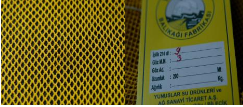
Şekil 4.41. Fabrikada üretilen düğümsüz küçük gözlü balık ağı
