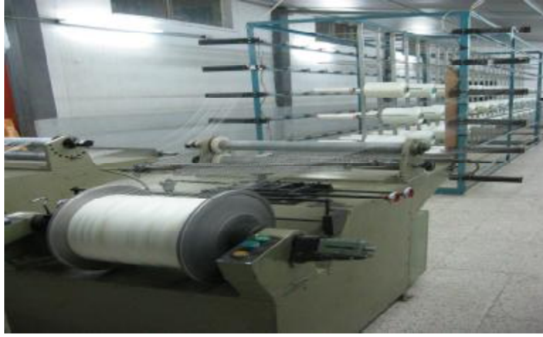
Şekil 4.10. Elyafın bobinlere sarılmasında kullanılan çözgü makinesi
