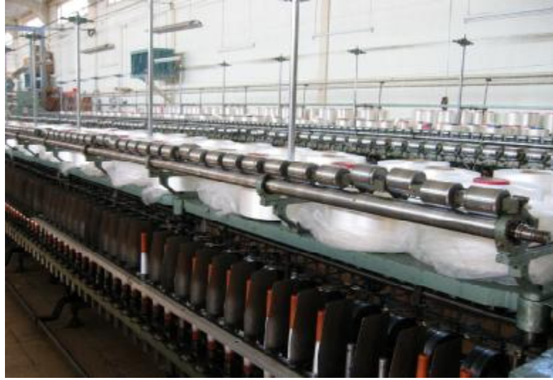
Şekil 4.4. Elyafın ipliğe dönüştürülmesinde kullanılan büküm makinesi
