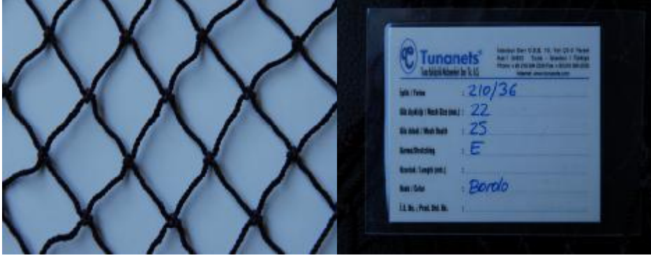
Şekil 4.38. Fabrikada üretimi yapılan düğümlü balık ağı
