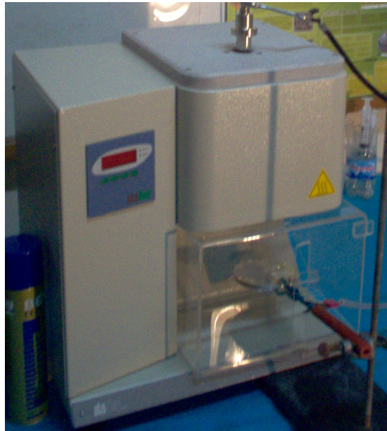
Şekil 9.2: Polimer Eriyiği Besleme Amaçlı Kullanılacak MFI Test Cihazı (ATS Faar)
