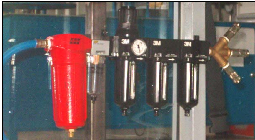
Şekil 6.4: Kompresörden gelen havayı temizleyen filtreler
