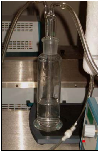
Şekil 7.2: Cl 2 gazının AgNO 3 içeren gaz yıkama şişesinde AgCl tuzu oluşturma evreleri
