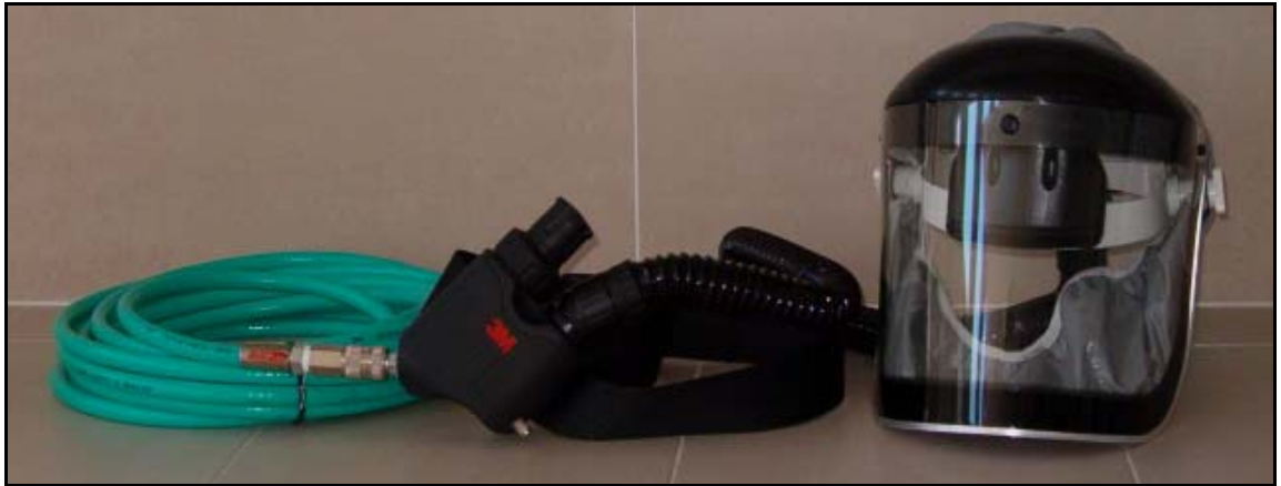
Şekil 6.5: Filtreden çıkan temiz havanın aktarıldığı solunum ekipmanları
