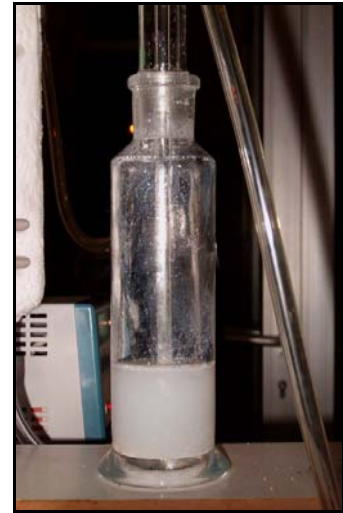
Şekil 7.2: Cl 2 gazının AgNO 3 içeren gaz yıkama şişesinde AgCl tuzu oluşturma evreleri
