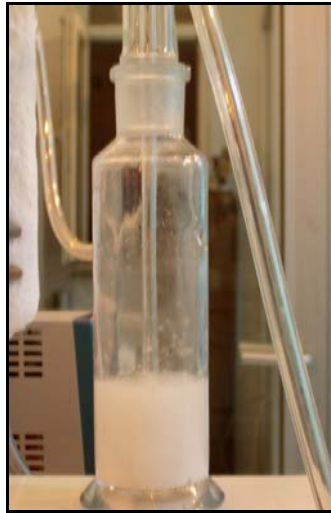
Şekil 7.2: Cl 2 gazının AgNO 3 içeren gaz yıkama şişesinde AgCl tuzu oluşturma evreleri
