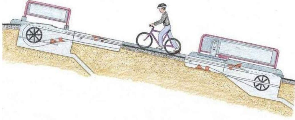
Şekil 3.42. Bisiklet Asansörü Sistemi, Norveç
