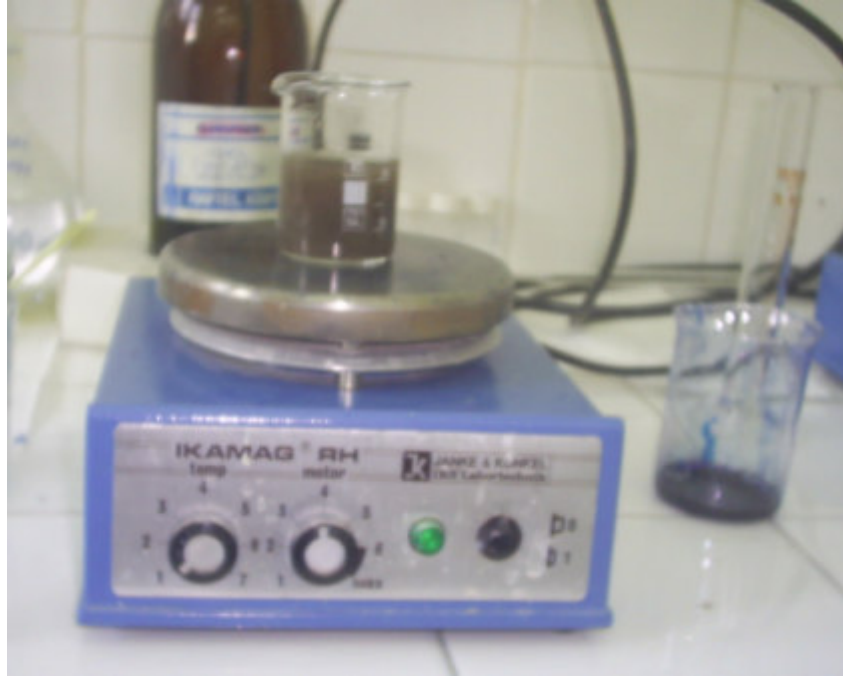
Şekil 6.4 : Manyetik Karıştırıcıda Metilen Mavisi Deneyi Numunesinin Hazırlanması-1
