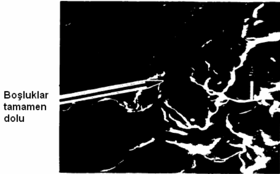
Şekil 4.11 : %50 Bentonit İçeren Kum-Bentonit Karışımında Bentonitin Şişerek Boşlukları Doldurması (Komine ve Ogata, 1996)
