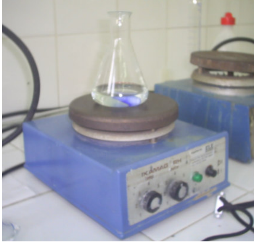
Şekil 6.5 : Manyetik Karıştırıcıda Metilen Mavisi Deneyi Numunesinin Hazırlanması-2
