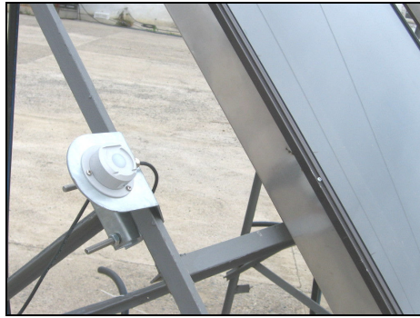
Şekil 3.9. Piranometrenin yeri ve bağlantısı.
