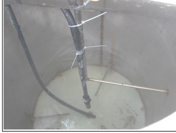
Şekil 3.5.b. Su tankının iç görüntüsü (rezistanslar ve sıcaklık sensörü)
