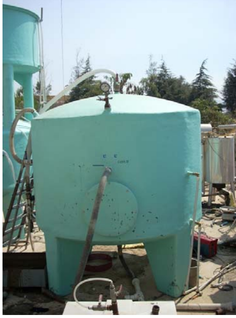
Şekil 3.5 5 m 3 kapasiteli fiberglass biyogaz reaktörü
