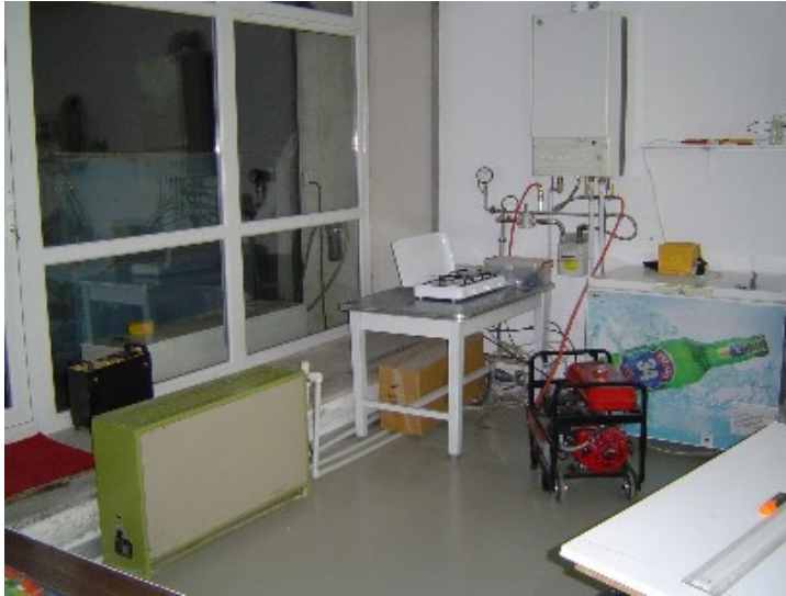
Şekil 3.12 Biyogazın pişirmede, sıcak su üretiminde, mekan ısıtmasında ve elektrik üretiminde kullanımına yönelik çalışmalar
