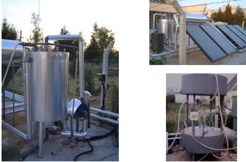
Şekil 3.1 Güneş enerjisi destekli sürekli tip biyogaz sisteminin görünümü
