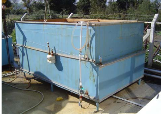
Şekil 3.8 5 m 3 kapasiteli biyogaz depolama tankının görünümü
