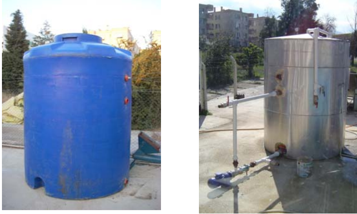
Şekil 3.3 Polietilen reaktörün yalıtım yapılmadan ve yapıldıktan sonraki görünümü.
