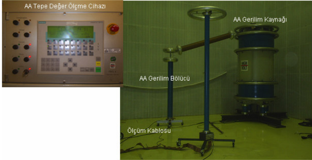
Şekil 3.2 Alternatif gerilim ölçüm sistemi
