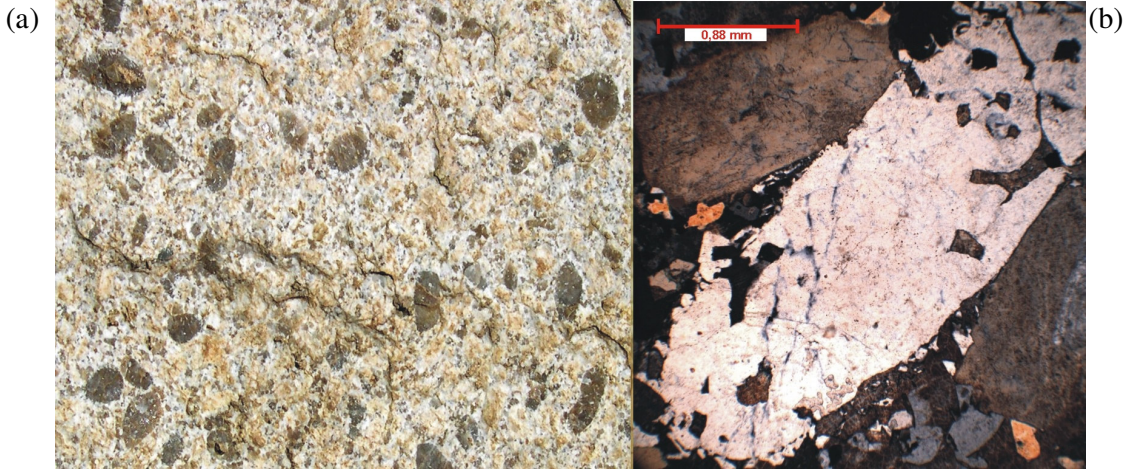
Şekil 4.16: İri kuvars kristalli, porfirik dokulu granodiyorit. Sol taraftaki resimde kayacın gözle görülen dokusu, sağ tarafta kayacın ince kesitinin çift nikoldeki görüntüsü (4x)
