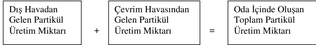
Şekil 7.1 Matematik modelin merkezi klima sistemine uyarlanması
