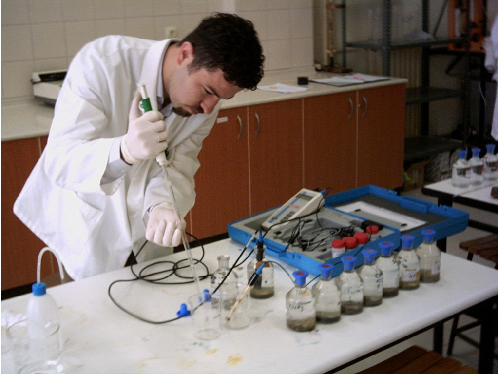
Şekil (Fotoğraf) 3.8. SOİ Tayini için BOİ Şişelerinde İnkübe Edilen Sediman Örneklerinde Analiz Aşaması
