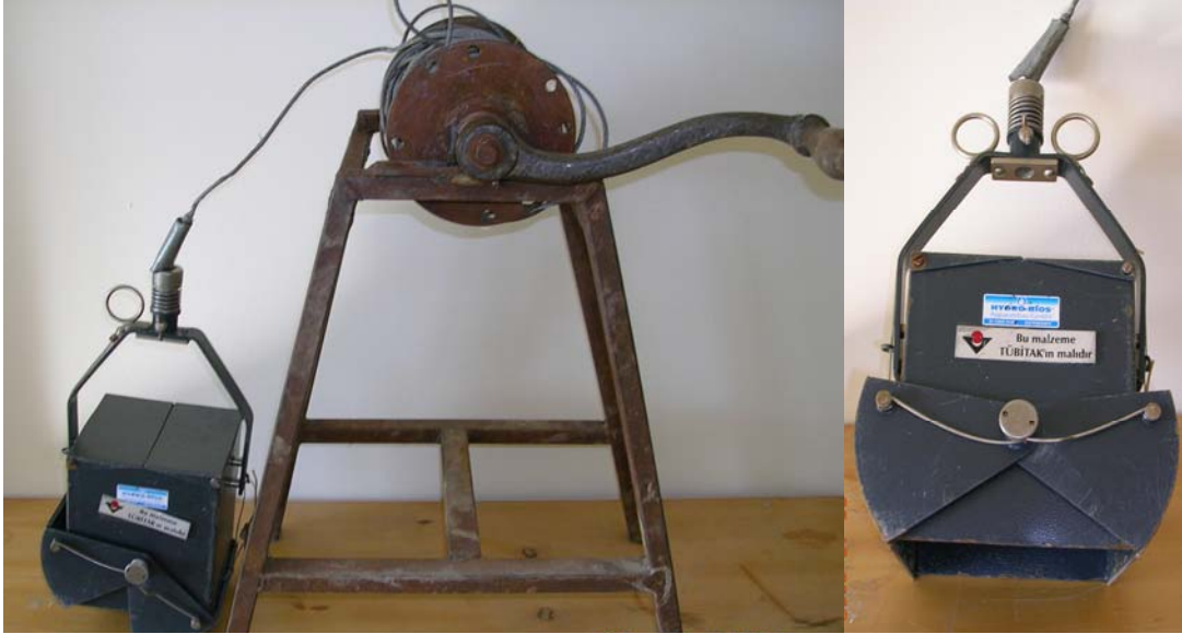
Şekil (Fotoğraf) 3.4. Çalışma Süresince Kullanılan Birge-Eckman Grab Sediman Örnek Alıcısı
