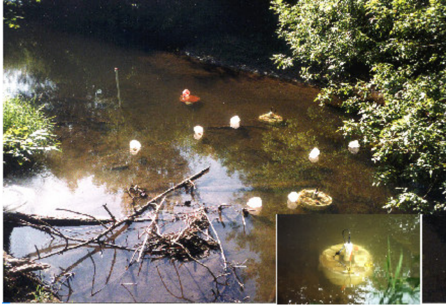
Şekil 2.11. Sediman Oksijen İhtiyacının Yerinde Ölçümü için Yapılan Örnek Bir Çalışma (Doyle ve Rounds, 2003)
