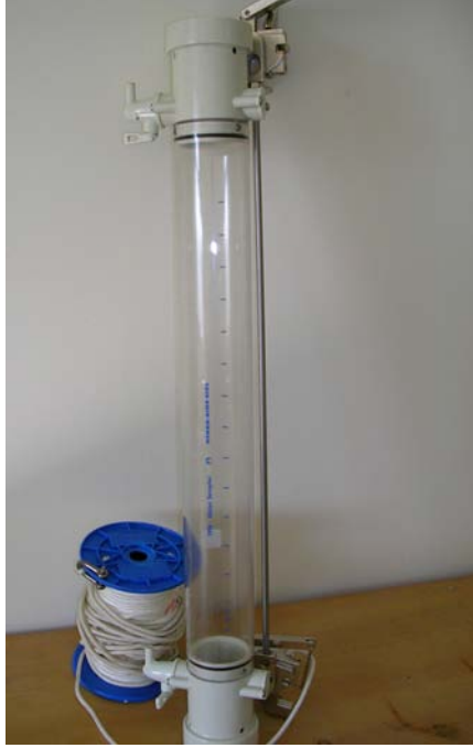
Şekil (Fotoğraf) 3.5. Çalışma Süresince Kullanılan Nansen Şişesi (TPN-Su Örnekleyici HYDRO-BIOS KIEL)
