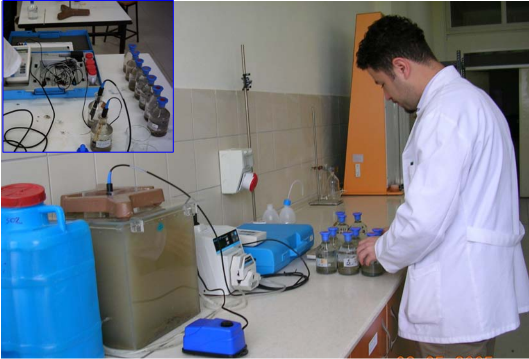
Şekil (Fotoğraf) 3.7. SOİ Tayini için BOİ Şişelerinde İnkübe Edilen Sediman Örnekleri ( Nisan 2005 dönemi)
