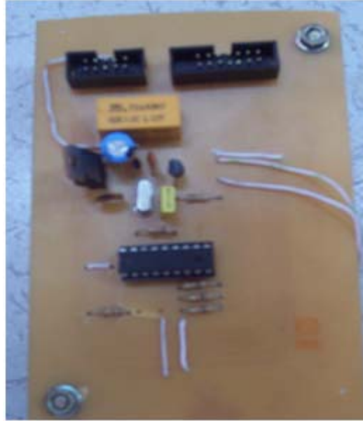
Şekil III.17 Şifreli Kapı Modülü
