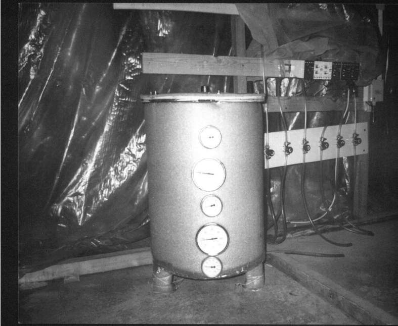
Şekil 3.2. Kompostlama sistemi düzeneđi
