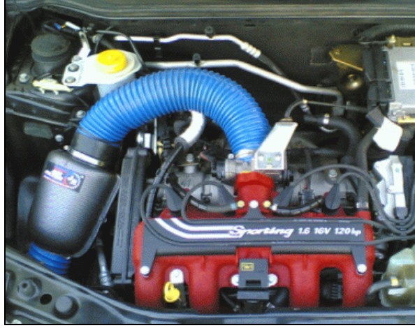
Resim 3.2. Performans tipi izolasyonlu bir hava filtresinin araç üzerindeki görünümü
