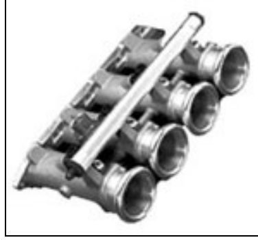
Resim 3.4. Her silindire ayrı bir kelebek boğazının borazan tabir edilen uygulanaşı
