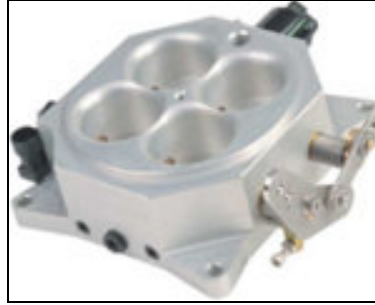
Resim 3.3. Her silindire ayrı bir kelebek boğazının karbüratörlü tip araçlardaki uygulanaşı
