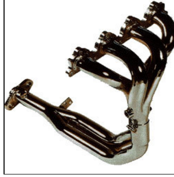
Resim 3.10. Akışa uygun düzenlenmiş egzoz manifoldu
