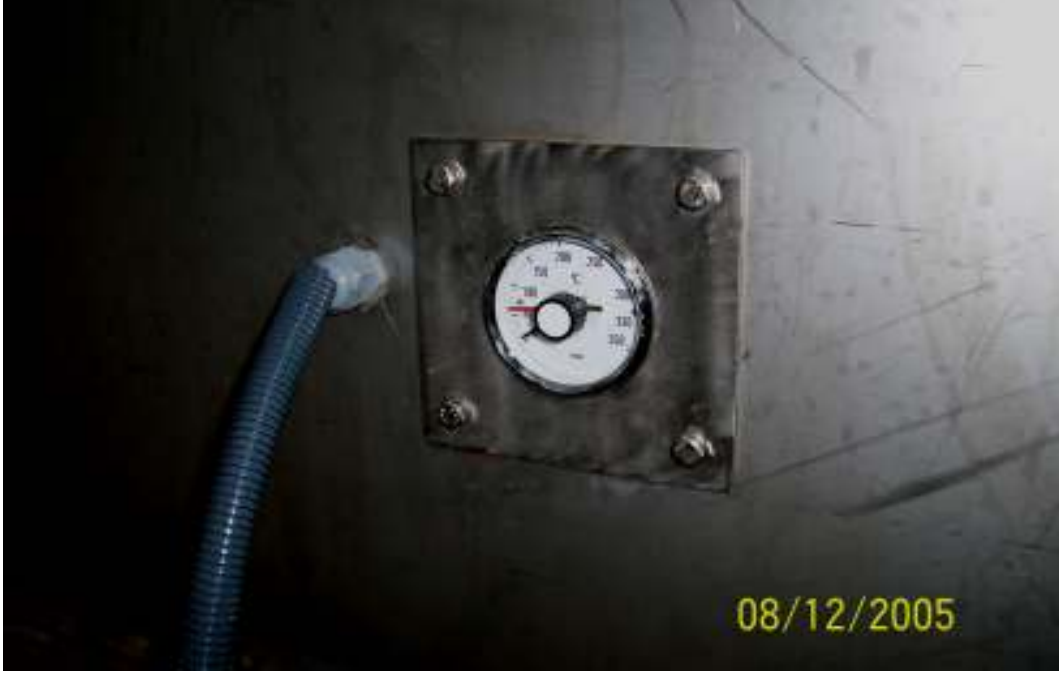
Şekil 3.9. FİİLİ SICAKLIĞI ÖLÇEN Bİ-METAL TERMOMETRE SKALASI
