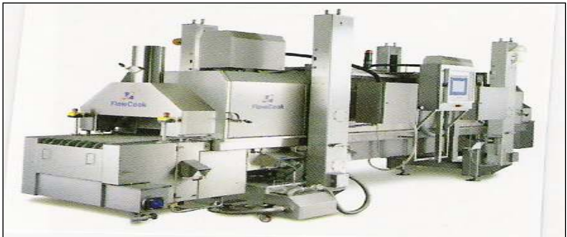
Şekil 2.6. DÜŞÜK KAPASİTELİ ÜRETİM İÇİN HOT AIR TURBO OVEN
