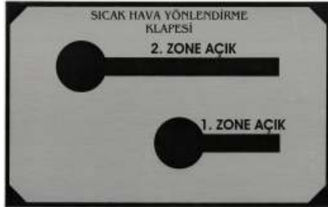
Şekil 3.10. ANA SICAK HAVA YÖNLENDİRME KLAPE POZİSYONLARI
