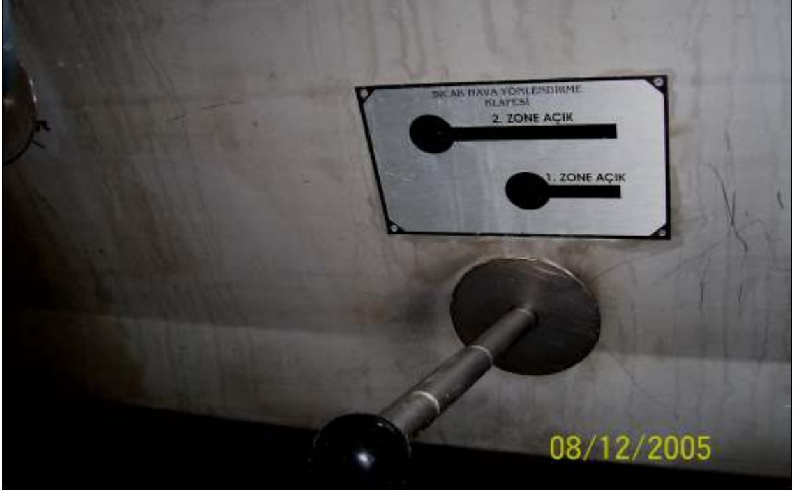
Şekil 3.11. ANA SICAK HAVA YÖNLENDİRME KLAPELERİ FIRIN ÜZERİNDEKİ DURUMU
