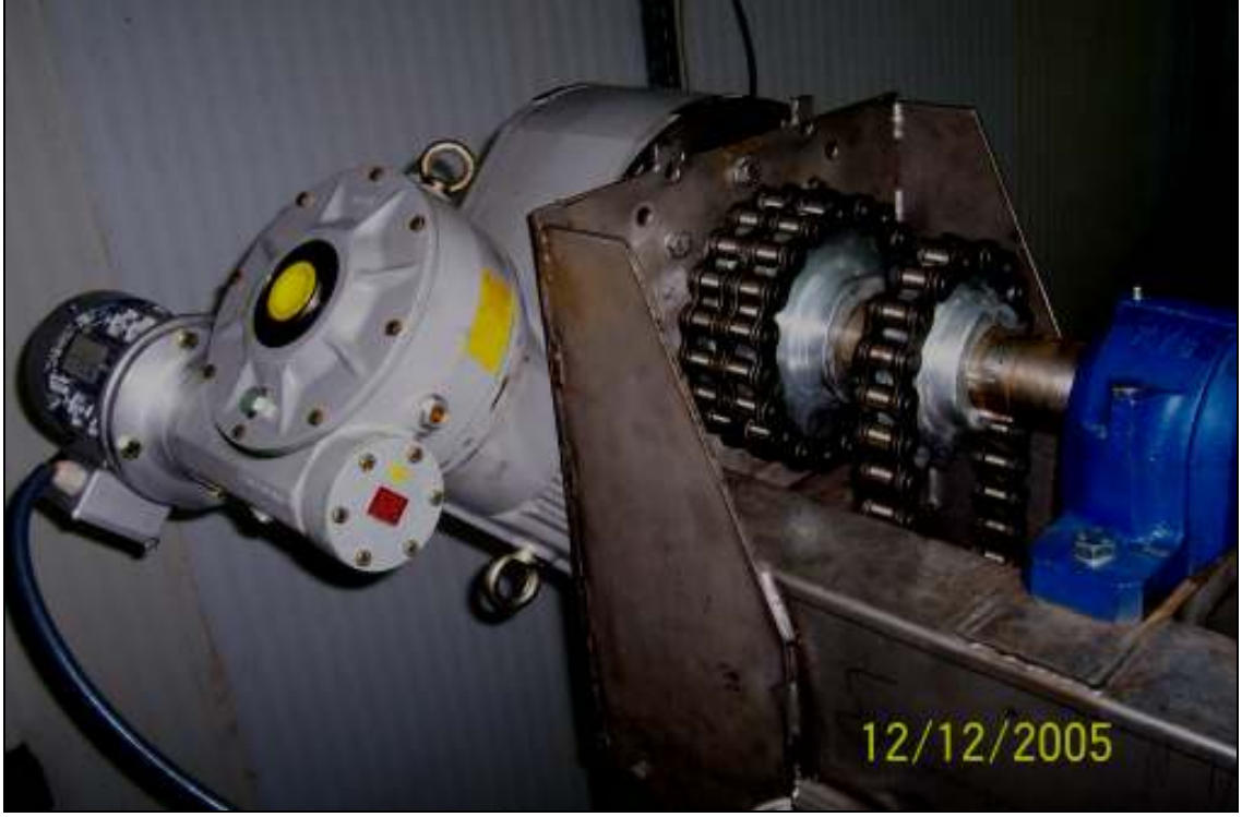
Şekil 4.4. FIRIN ÜST KISIM KALDIRMA REDÜKTÖRÜ MONTAJI HALİ
