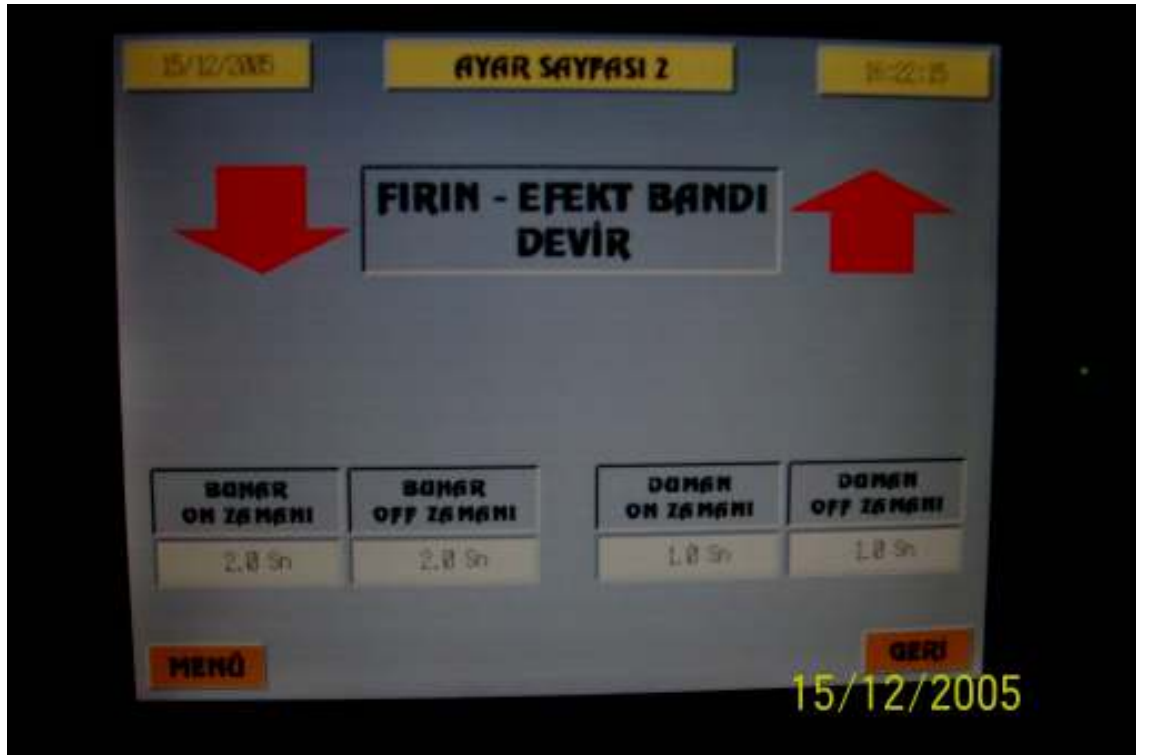
Şekil 3.2. FIRIN ELEKTRİK PANOSU PİŞİRİCİ BANDI HIZ AYAR SAYFASI
