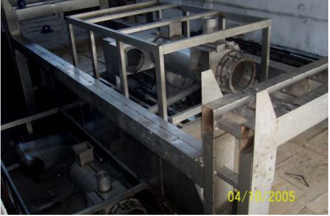
Şekil 3.7. İMALAT AŞAMASINDAKİ YANMA HÜCRELERİ VE FIRIN ŞASESİ
