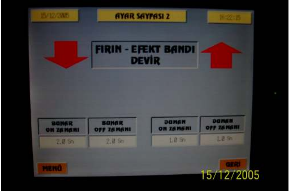
Şekil 3.16. DOKUNMATİK (TOUCH SCREEN) EKRAM HIZ SAYFASI
