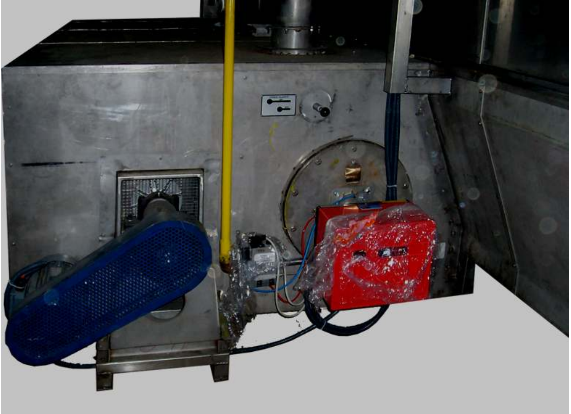
Şekil 3.8. BRÜLÖR MONTAJ EDİLMİŞ YANMA HÜCRESİ
