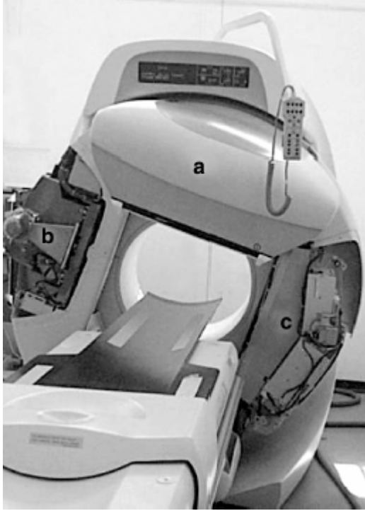
Şekil 2.1. Hibrit SPECT/CT tarayıcı Hawkeye( GE medical sistemler). Tarayıcı, düşük çözünürlüklü ve düşük fiyatlı olan X-ışın CT kamera, bu karmanın parçaları olan X ışın tüpü (b), 384 adet CdWO_4 çizgi tarayıcı(c) ile çift kafalı SPECT( (a) ile gösterilmiştir)ten oluşmaktadır .
