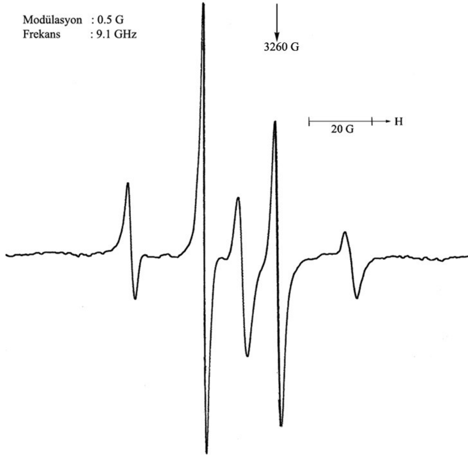
Şekil 5.8. \gamma -ışınları ile ışınlanan \text{Li}_2\text{KNH}_4(\text{SO}_4)_2 toz kristalinin 113 K'de kaydedilen EPR spektrumu
