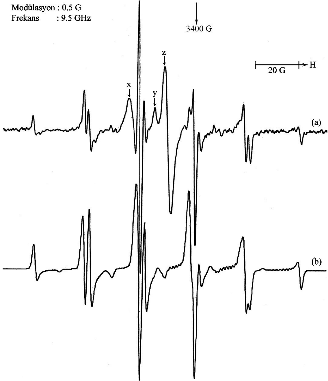
Şekil 5.12. \gamma -ışınları ile ışınlanan \text{LiK}_{0.97}(\text{NH}_4)_{0.03}\text{SO}_4 tek kristalinin a) toz kristal EPR spektrumu b) spektrumun simülasyonu
