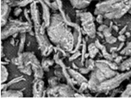
Şekil 4.8b. 75 W 20 dak plazma sonrası Na-aljinat (500*)
