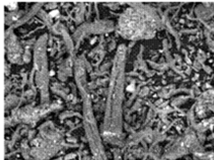
Şekil 4.7e. 125 W 40 dak plazma sonrası \kappa -karajenan (500*)
