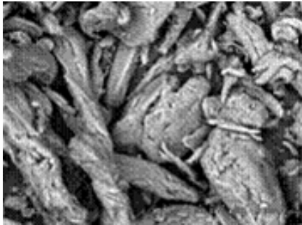
Şekil 4.8d. 125 W 20 dak plazma sonrası Na-aljinat (500*)
