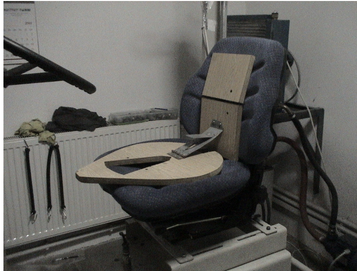
Şekil 3.22 Koltuk referans noktası belirleme aparatı
