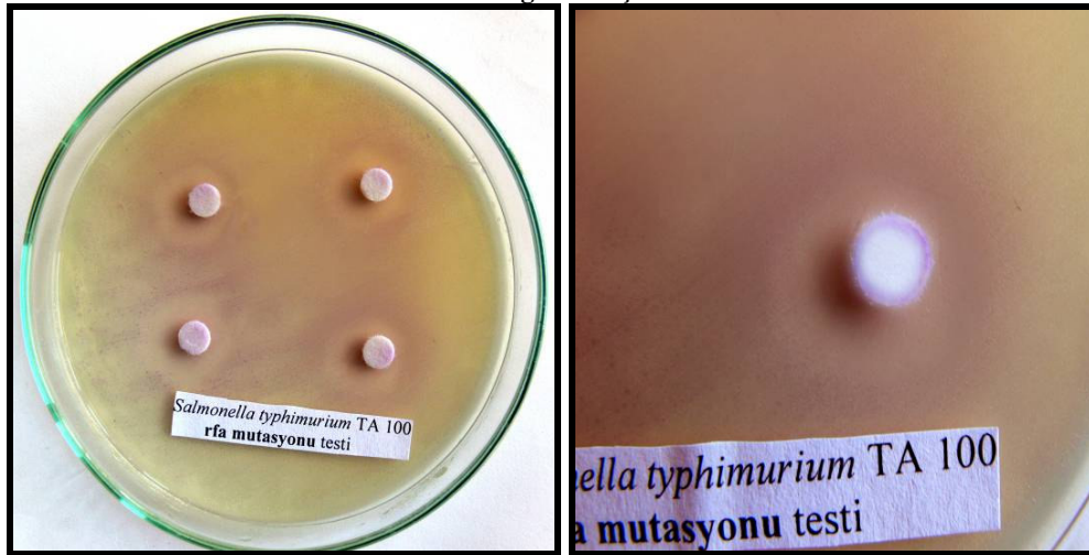
Şekil 3.2.2.6. S. typhimurium TA 100 de rfa mutasyonu kontrolü .14 mm çapında inhibisyon zonları görülmüştür.
