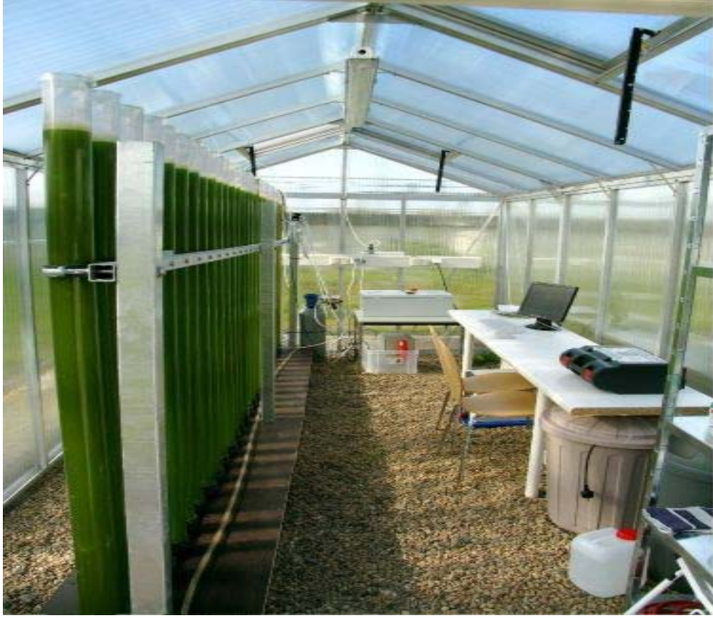
Resim 3.11. Sera ortamında fotobiyoreaktörde Spirulina üretimi ( http://www.irccm.de/greenhouse/project.html )
