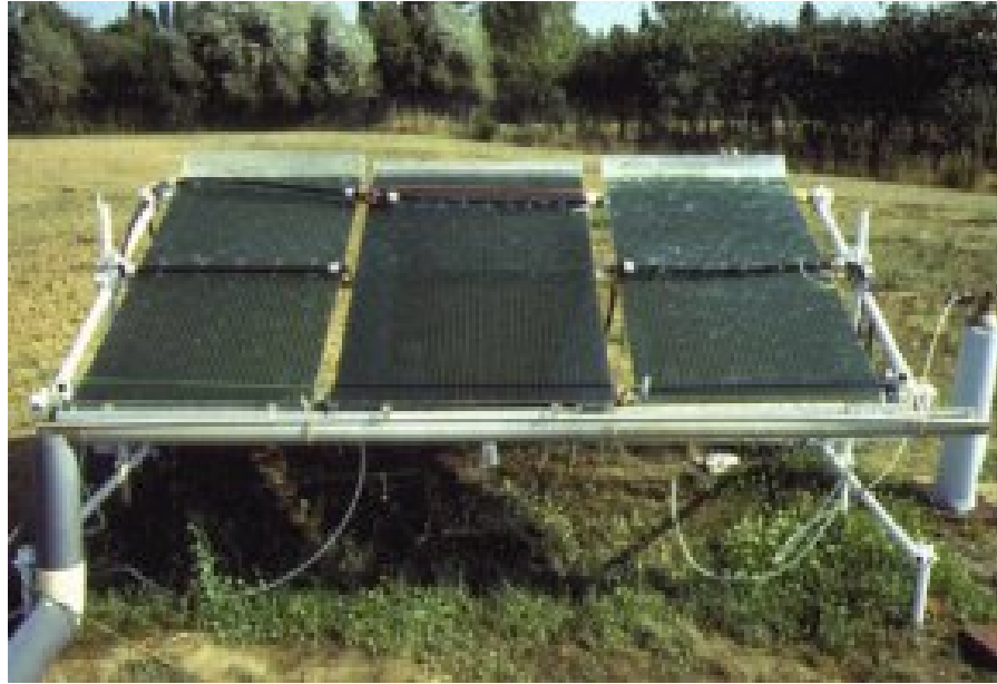
Resim 3.10. A ık sistem t b ler fotobiyoreakt rde Spirulina  retimi ( http://www.irccm.de/greenhouse/project.html )
