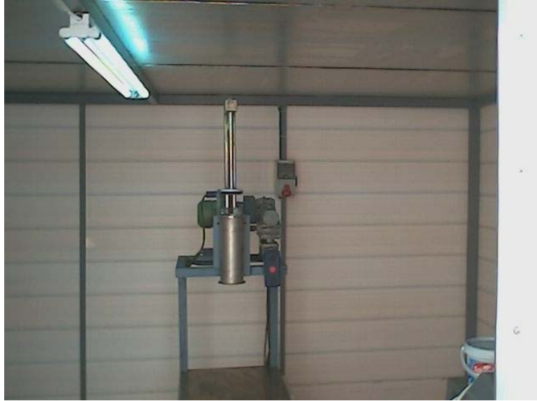
Resim 4.4.3 Spagetti pres makinesi(orijinal)
