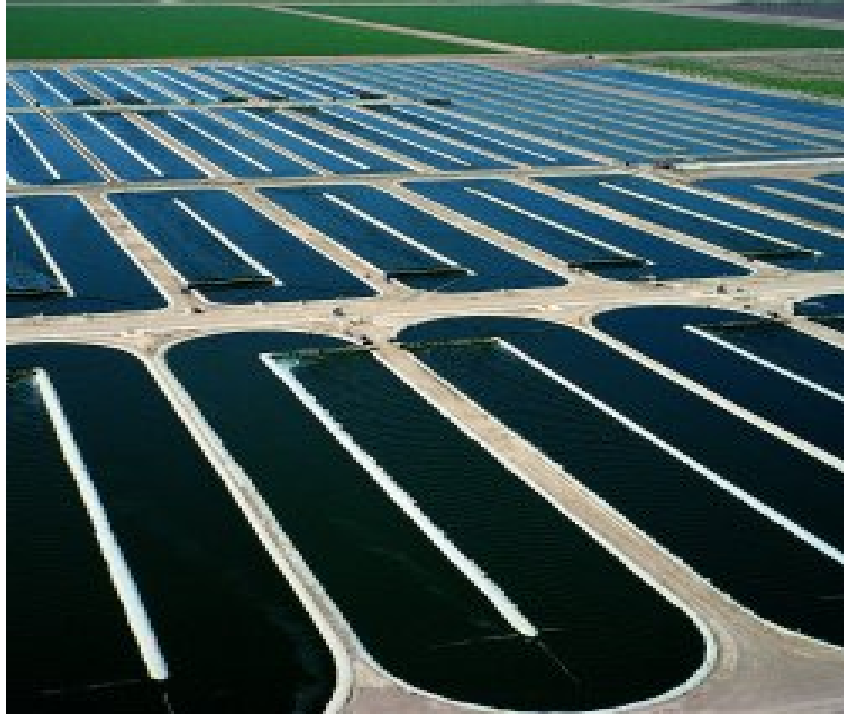
Resim 3.2 Açık kanal tipi havuz sistemlerinde Spirulina üretimi ( www.relife.com/Images/earthrise-farm-180w-opt.gif )
