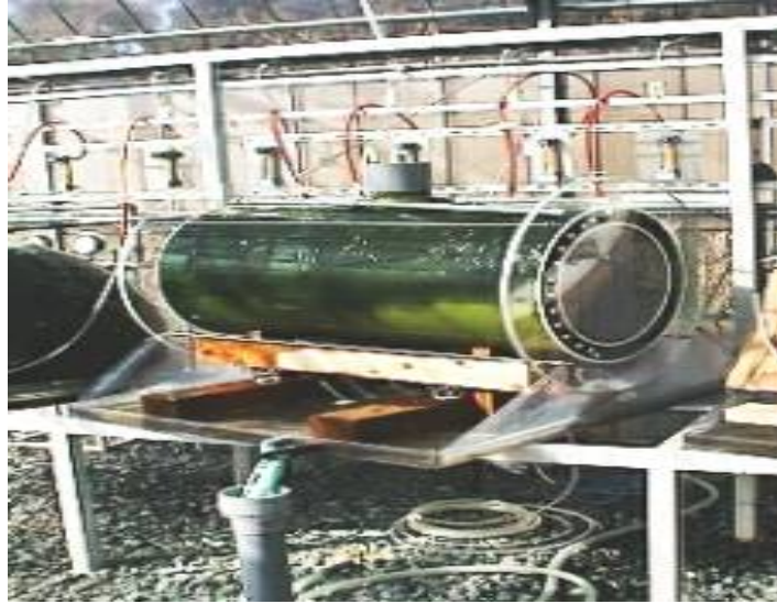
Resim 3.8. Fotobiyoreaktörde Spirulina üretimi ( http://lemons.k.u-tokyo.ac.jp/SATO/research/Ghgt/reactor.htm )
