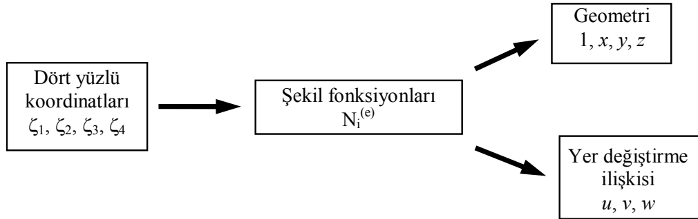
Şekil 4.9. Dört yüzlü elemanın izoparametrik gösterimi [116]
