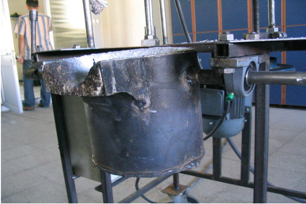
Şekil 3.1.c. Potanın masaya yerleştirilmesi
