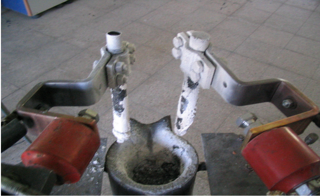
Şekil 3.3.c. Elektrot tutucu kolların fotoğrafı
