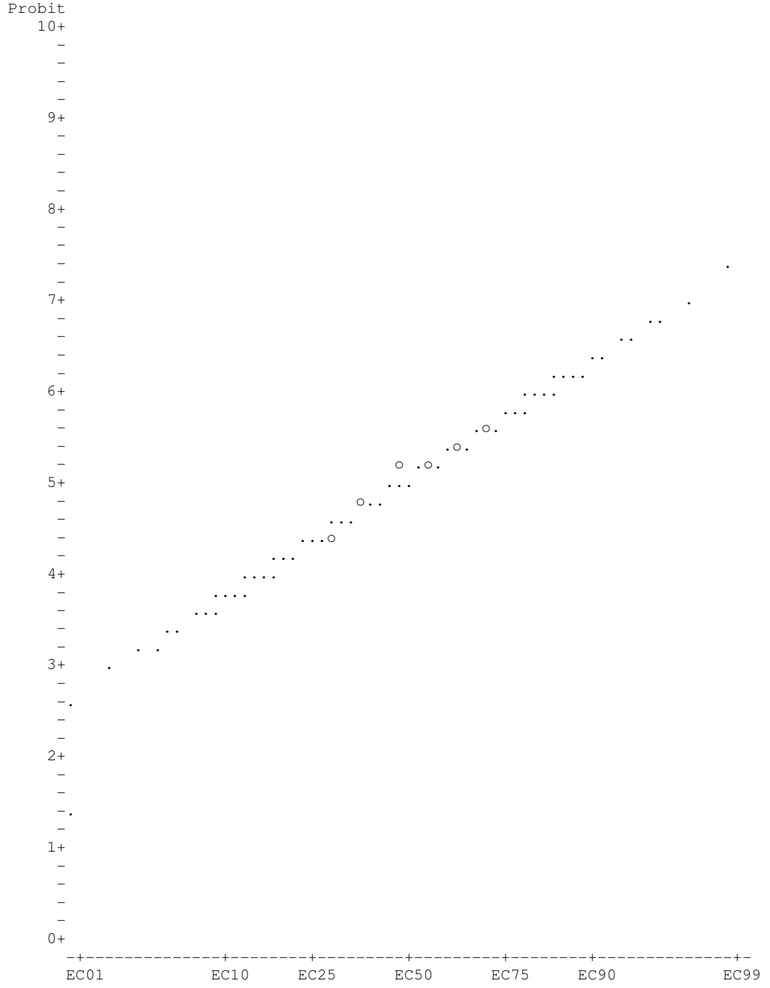
Şekil 4.4 %60 etoksisulfuron içeren herbisitinin ana deney derişimleri ile inhibisyon yüzdelерinin probitleri arasındaki ilişki
