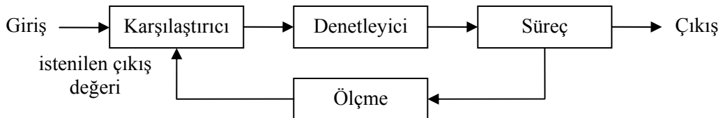
Şekil 5.3. Kapalı çevrimli sistem blok şeması
