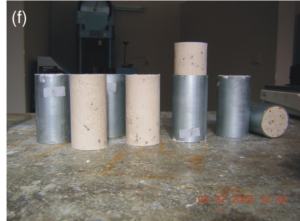
Şekil 3.4. Yapay bimrockın hazırlanmasında kullanılan (a) karışım malzemeleri, (b) matriks karışımı, (c) ve (d) matriks ve blok karışımı, (e) 54 mm çaplı ve 110 mm yüksekliğindeki silindirik kalıbın içerisine karışımın konulması ve (e) havada kurutulmak için kalıplardan dışarı alınan örnekler.
