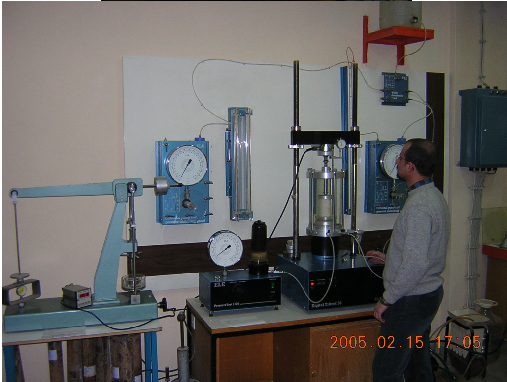
Şekil 3.6. Yapay bimrock örnekleri üzerinde uygulanan üç eksenli deneyden bir görünüm.
