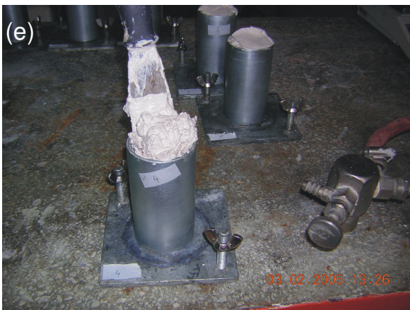
Şekil 3.4. Yapay bimrockın hazırlanmasında kullanılan (a) karışım malzemeleri, (b) matriks karışımı, (c) ve (d) matriks ve blok karışımı, (e) 54 mm çaplı ve 110 mm yüksekliğindeki silindirik kalıbın içerisine karışımın konulması ve (e) havada kurutulmak için kalıplardan dışarı alınan örnekler.
