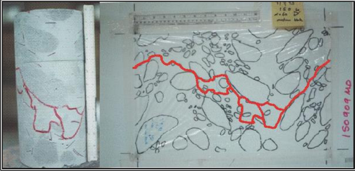
Şekil 2.14. Model bimrock karot örneğinde yenilme yüzeyinin gelişimi (Lindquist, 1994'den).
