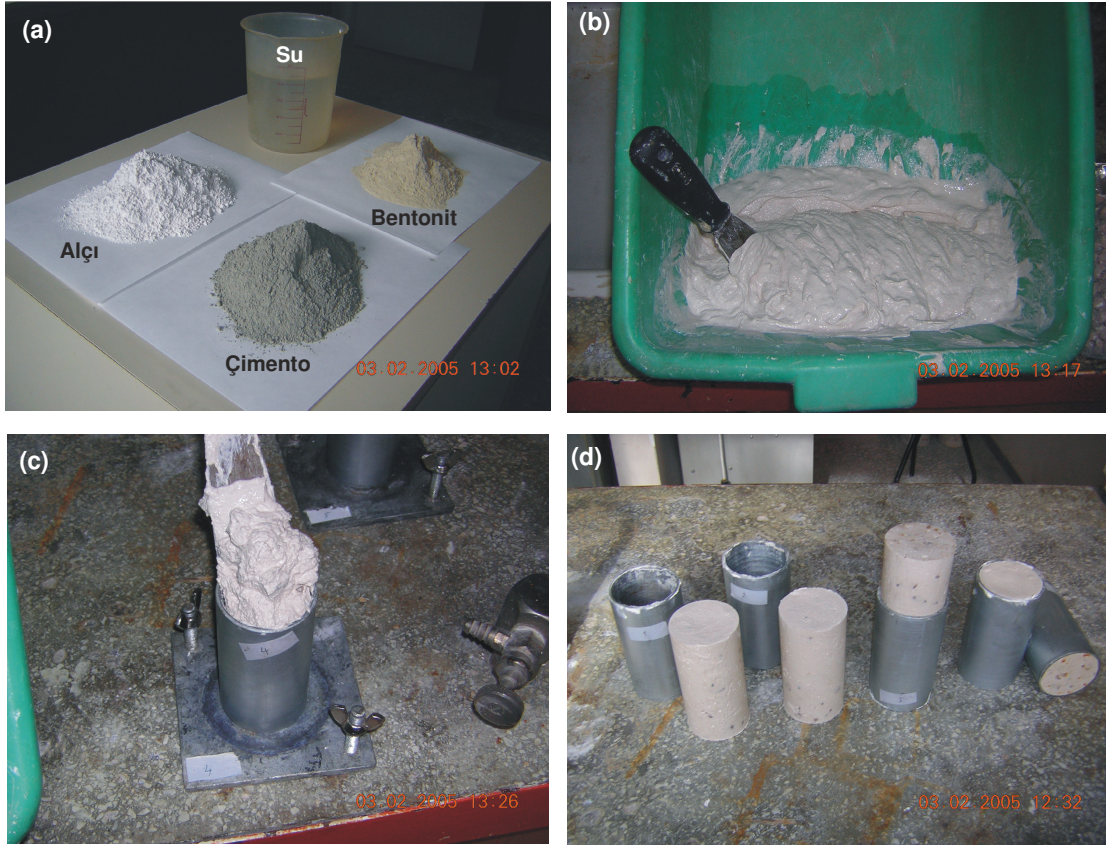
Şekil 3.2. Yapay matriksin hazırlanmasında kullanılan (a) karışım malzemeleri, (b) karışım harcı, (c) 54 mm çaplı ve 110 mm yüksekliğindeki silindirik kalıbın içerisine karışımın konulması ve (d) havada kurutulmak için kalıplardan dışarı alınan örnekler.
