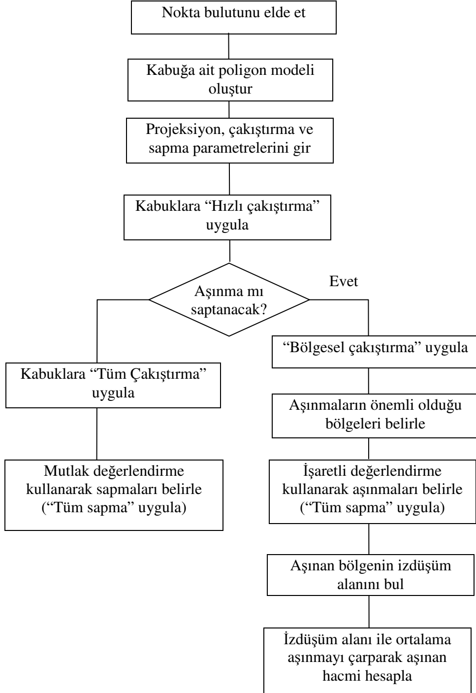
Şekil 3.15 Tekrarlanabilirliğin ve aşınmaların saptanması için kabuklara uygulanacak işlemler
