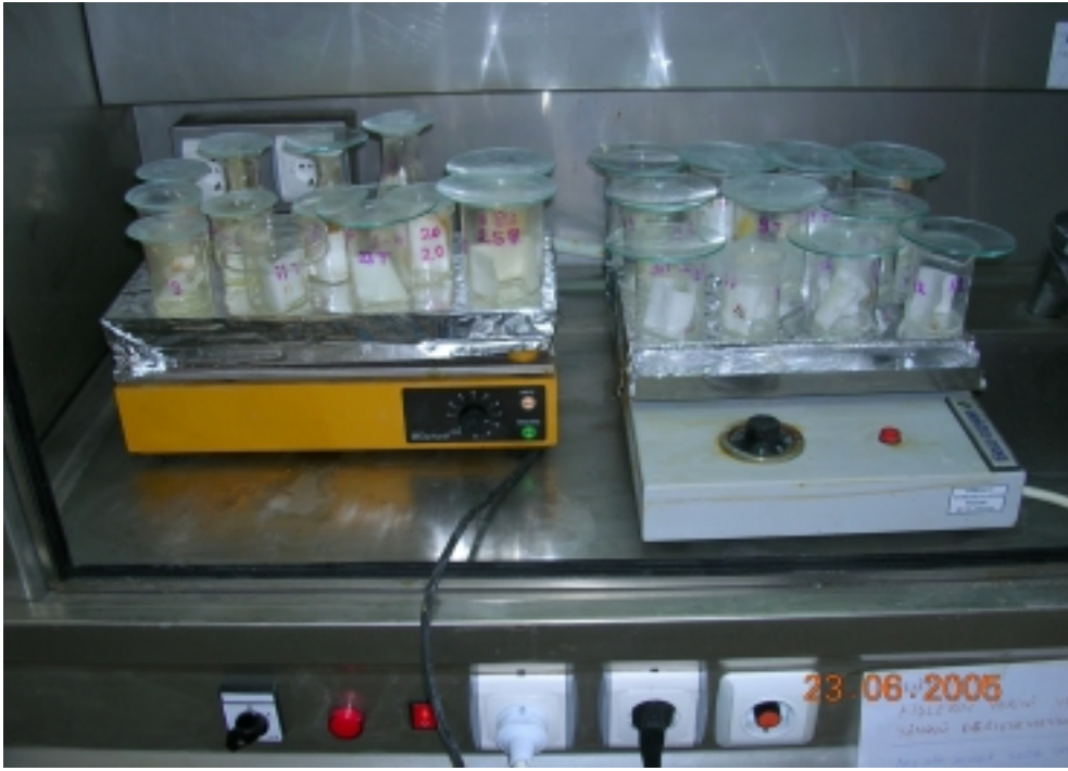
Resim 3.6. Hot-Plate Üzerinde Metal Sindirimi Yapılmakta Olan Örnekler
