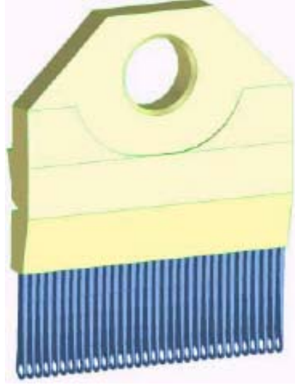
Şekil III.10 : Blok Halinde Çözümlü Örmeye Kullanılan Delikli Yatırım Elemanının Görünüşü [25].
