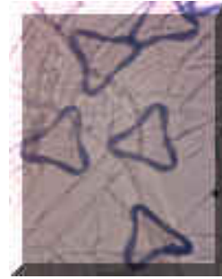
Şekil III.34 : Trilobal enine kesitli iç/dış bikomponent lif [21].
