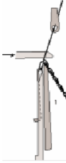
Şekil III.13: İğneler Aşırtma Konumunda, Önceki İlmek Kursunun Tamamlanmasından Sonra İğne ve Diğer Örmek Elemanları En Alçak Pozisyonda Bulunuyor. Tutucu Platinler İğneler Arasına Yerleştirilir ve Yeni İlmek Oluşturmak İçin Örmek Elemanları Kademe Kademe Hareket Etmeye Başlarlar [5].
