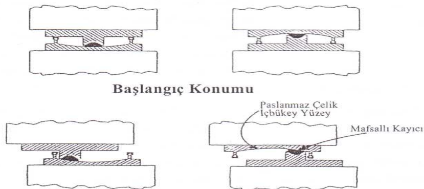
Şekil 3.13 Sürtünmeli sarkaç sistemlerin başlangıç ve yerdeğiştirme konumları
