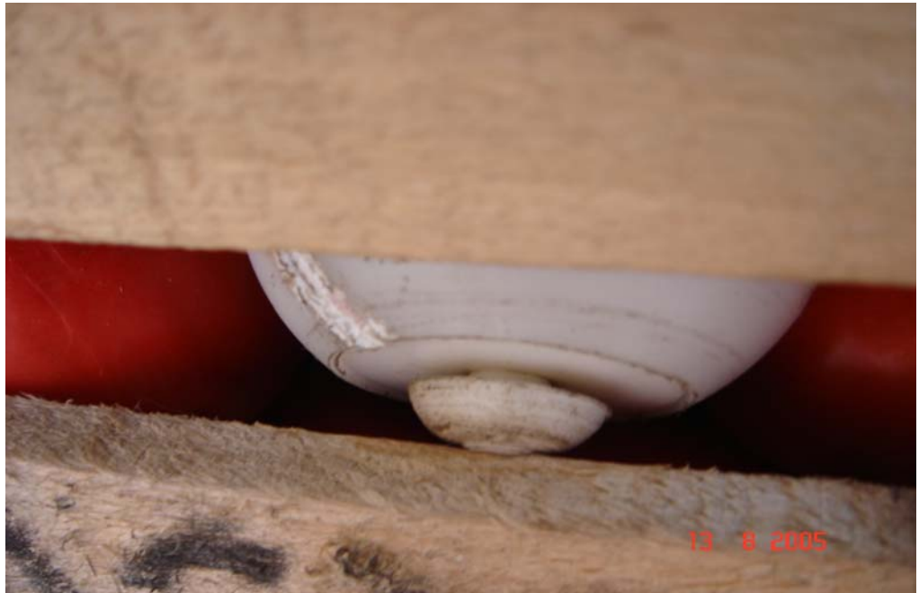
Şekil 3.23. Kasa Malzemesi Keskin Kenarlarında Oluşan Kuvvetlerin Ölçümü
