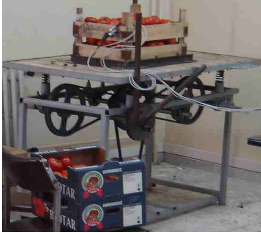
Şekil 3.31. Kasa Sarsıcı Düzeneği ve Çift Sıralı Domates Kasasının Düzenek Üzerindeki Konumu
