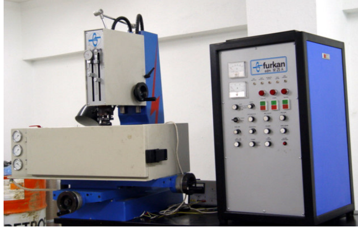
Şekil 3.5. Çalışmada kullanılan elektro erozyon tezgahı
