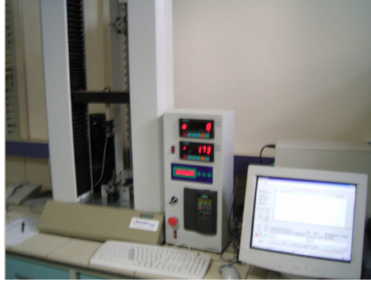
Şekil 3.9 Üç nokta deneylerinde kullanılan test cihazı
