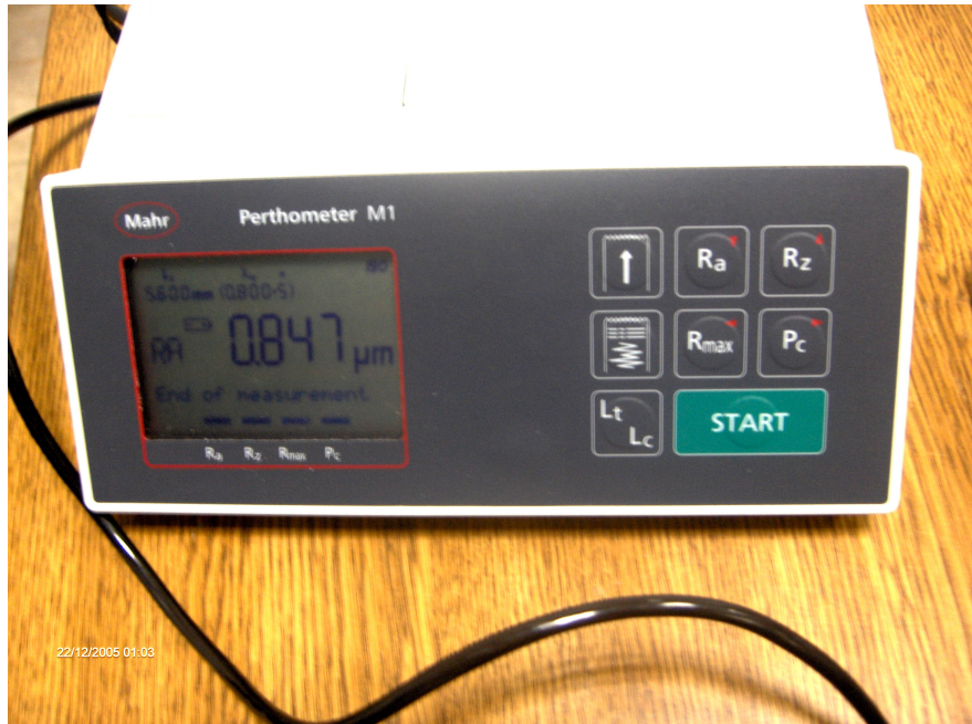
Şekil IV.7 MAHR-PERTHOMETER M1 Yüzey Pürüzlülüğü Ölçüm Cihazı
