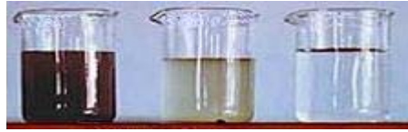
Şekil 2.16. Sol taraftaki atık su örneğinde , COD* değerlerinin ozon işleminden sonra 8,800 mg./l.'den , 120 mg./l.'ye düştüğü görülmektedir. (COD: Kimyasal oksijen ihtiyacı) ( http://www.yagmurteknik.com.tr , 2005)
