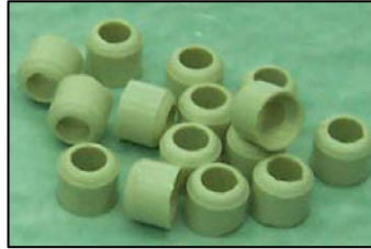
Şekil 3.4 Kule ierisinde kullanılan Raschig halkaları
