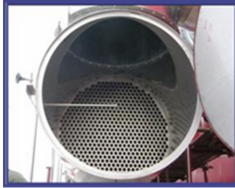
Şekil 2.29 Gövde-borulu ısı değiştirici enine kesiti
