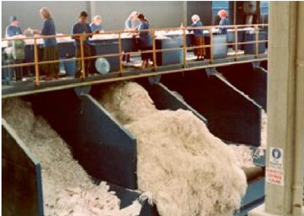
Resim 4.8. Atık kâğıt ayırma tesisinden görünüm (ayırma bandı)
