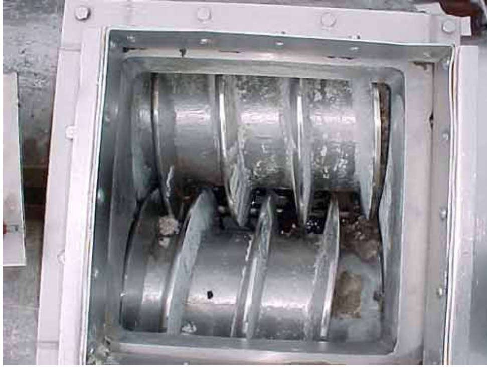
Resim 5.1. Pulper'den kesit görünüm
