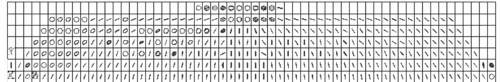
Şekil 10. \Delta_A=10 mm, P=286 kN iken oluşan çatlaklar
