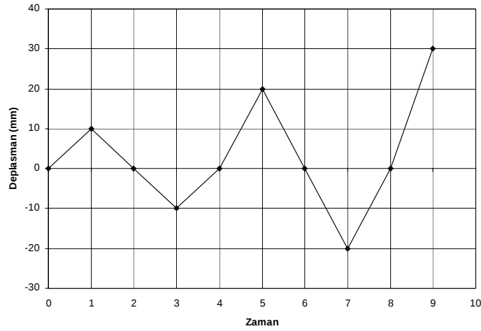
Şekil 7.34 Tersinir tekrarların deplasman yüklemesi ( \Delta u=10 mm)
