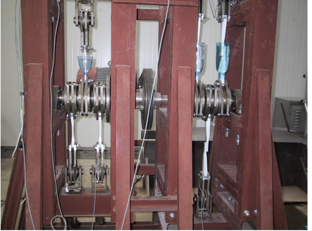
ŞEKİL 5.5. Test makinası ve numunelerin deniz ortamındaki testleri (Erbil, 2005)
