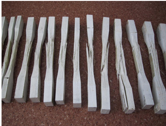
ŞEKİL 5.4. Delaminasyona uğrayan (kırılan) numuneler (Erbil, 2005)
