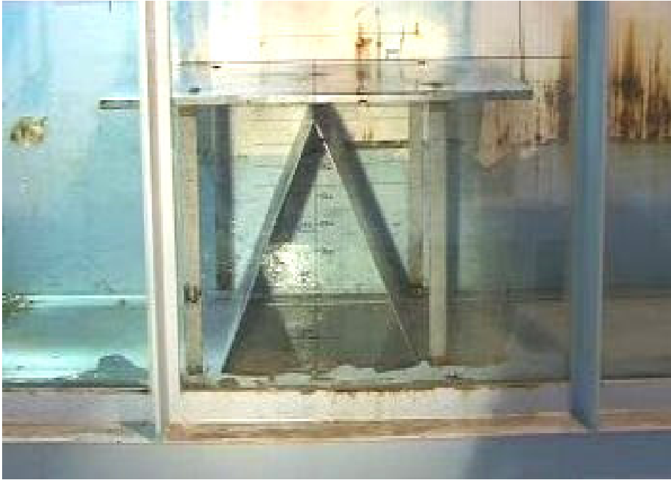
Şekil 4.12 Plaka altında üçgen levhalı “A 6 ” ölçüm serisi deney düzeneği.
