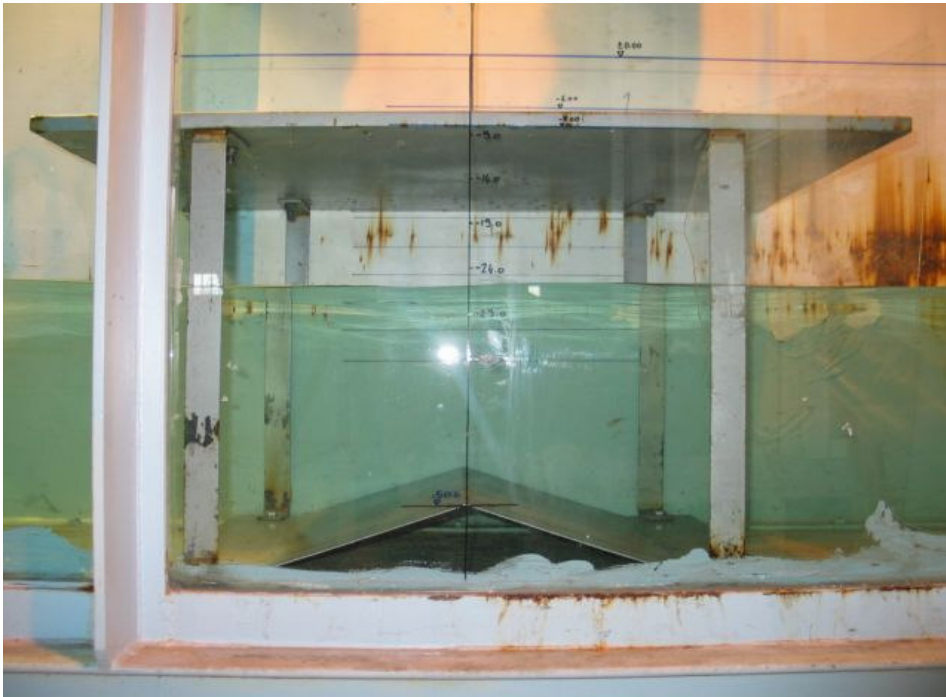
Şekil 4.8 Plaka altında üçgen levhalı “A 2 ” ölçüm serisi deney düzeneği.
