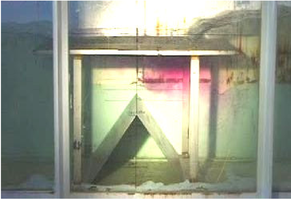
Şekil 4.10 Plaka altında üçgen levhalı “A 4 ” ölçüm serisi deney düzeneği.
