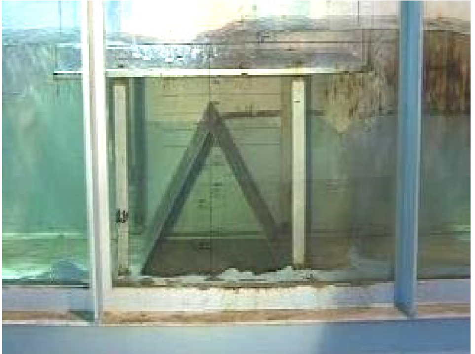
Şekil 4.11 Plaka altında üçgen levhalı “A 5 ” ölçüm serisi deney düzeneği.
