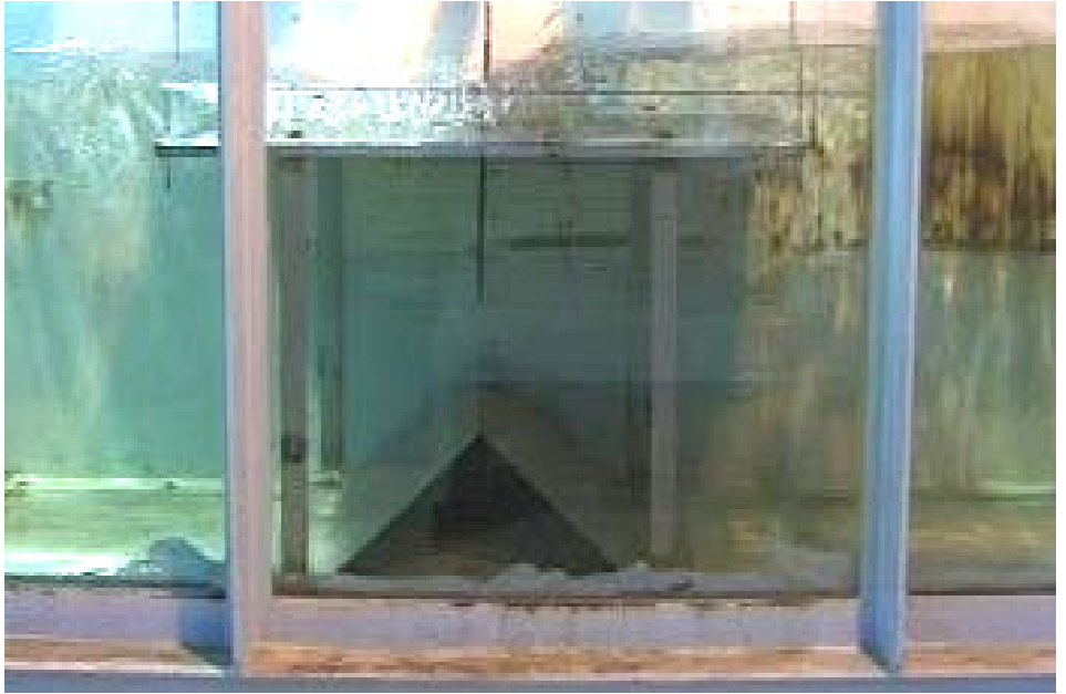
Şekil 4.9 Plaka altında üçgen levhalı “A 3 ” ölçüm serisi deney düzeneği.
