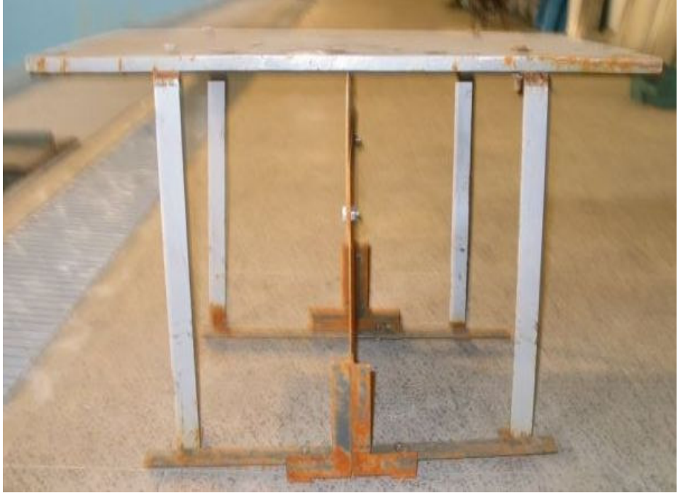
Şekil 4.13 Plaka altında dikdörtgen levhalı “A 55 ” ölçüm serisi deney düzeneği.
