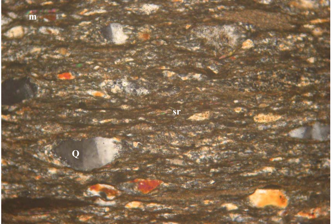
Şekil 2.13: Kuvars fillitlerde gözlenen granolepidoblastik doku. Kuvars (Q), serisit (sr), muskovit (m). ( Ç.N.X5; 1cm 0.1 mm 'yi göstermektedir).
