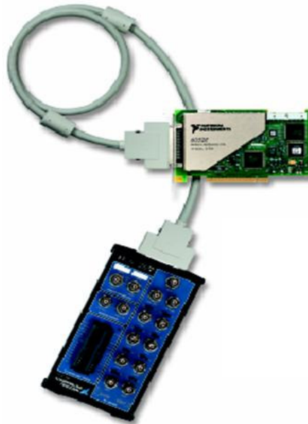
Şekil 4.16: BNC 2110 terminal ve SH 68E kablo
